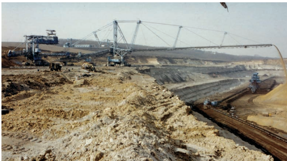
Közvetlen átrakó berendezés a Nyugati bányában
