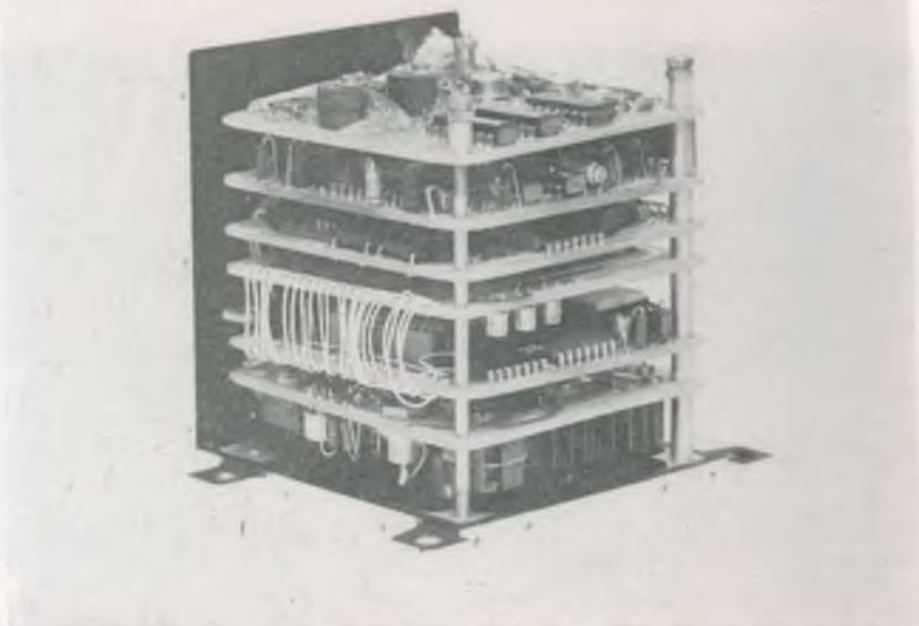
X. tábla 1. kép A LAM-1 ionoszféra-kutató műszer. Repült a Vertikál—6 és Vertikál—7 rakétákon
