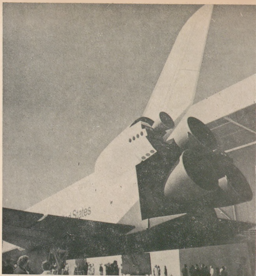
41. ábra. A manőverhajtóművek, alsó képen a hajtómű fékpádon
