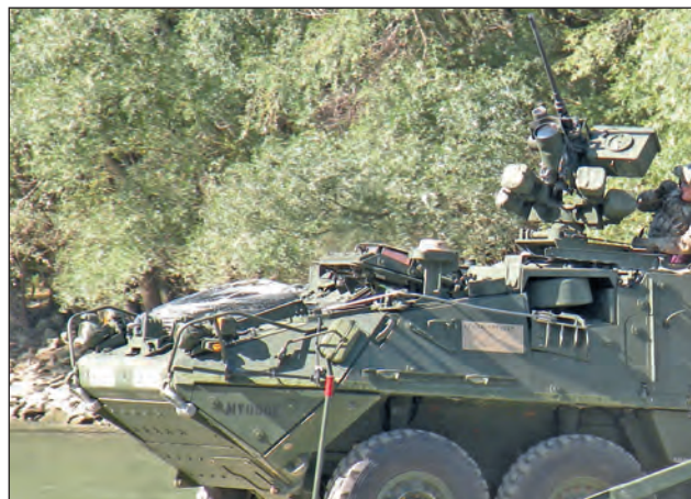
4. ábra. A távirányítású fegyverállvány a hőkamerával, és M2-HB géppuskával
