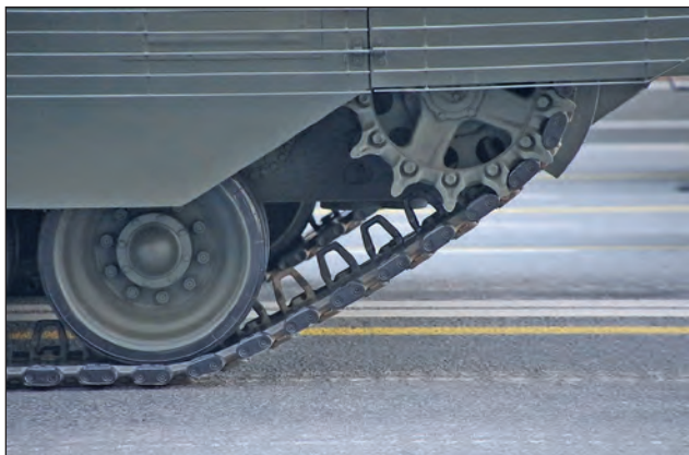
21. ábra. A lánctalp tömegének csökkentése érdekében az áttört lánctarajokat könnyítették
