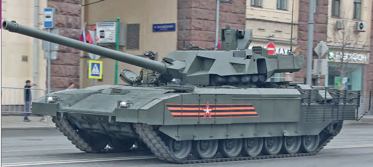
17. ábra. A harckocsi mozgás közben (bal oldal). A harckocsitorony alján láthatók az aktív védelmi rendszer csapásmérő elemei
