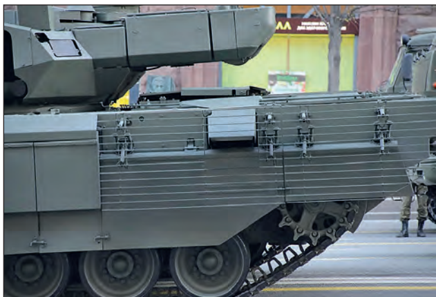
20. ábra. A harckocsi hátulsó részén látható a kumulatív löszer elleni rácsozat, középen pedig a motor bal oldali kipufogónyílása
