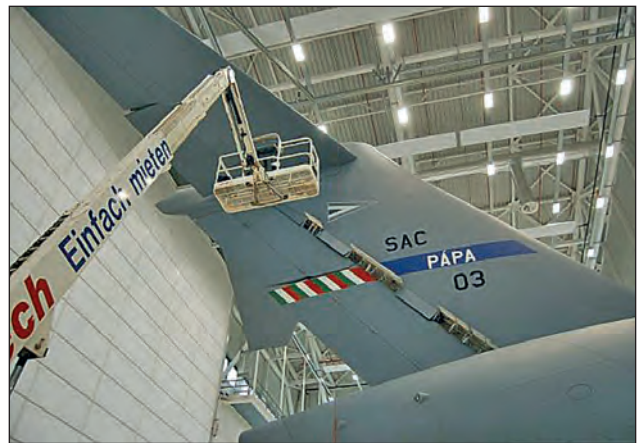
13. ábra. A NATO nehéz légiszállító ezred magyar felségjelű C 17-es szállító repülőgépének nagy méretű függőleges vezérsíkját emelőkosaras kocsival ellenőrzik az új pápai hangárkomplexumban. A fedett, klimatizált épület és a speciális berendezések költséghatékonyabbá tették a nehéz szállító repülőgépek üzemeltetését, mert a karbantartási munkálatokra nem kell az Egyesült Államokba repülni
