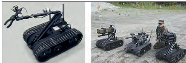
2. ábra. Az amerikai TALON robot aknamentesítő (balra), illetve fegyverrel ellátott változatai (jobbra)
