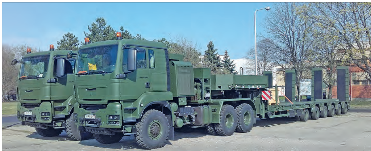
7. ábra. Az ábrán a Magyar Honvédség MAN TGS 40.540 6x6 BBS MIL vontatója Goldhoffer STZ-H 6 nehéz félpótkocsival. A 74 000 kg teherbírású szerelvény a rendszeresítés alatt álló Leopard 2-es harckocsi és PzH 2000 önjáró löveg is gazdaságosan szállítható
