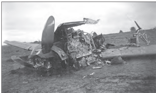
9. ábra. Közeleli felvétel a Bf 109-es kiégett és összetört orr-részeről és szárnyairól
