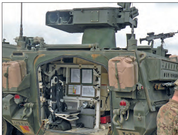
6. ábra. M1134-es irányított páncéltörő rakéta-hordozó lehajtott hátsó rámpával. Jól látható a küzdőtér egy része, és a torony bal oldalán a TOW-2-es rakéták indítócsövei
