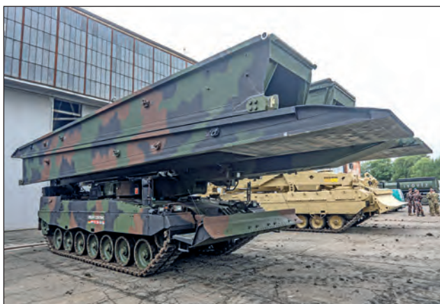
7. ábra. A Leopard Leguan hídvető harckocsival könnyen és gyorsan áthidalhatók a műszaki zárok, vízmosságok és kisebb folyók. A Leguan által telepített hidakon átkelve a Leopard 2-es harckocsik és más járművek folyamatos mozgásban maradhatnak (Fotó: HM Zrínyi Kft. Dévényi Veronika)
