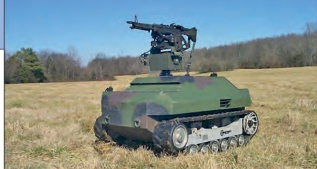
4. ábra. Az amerikai tengerészgyalogság által 2007-ben rendszeresített láncaltalpas harci robot, a Gladiator
