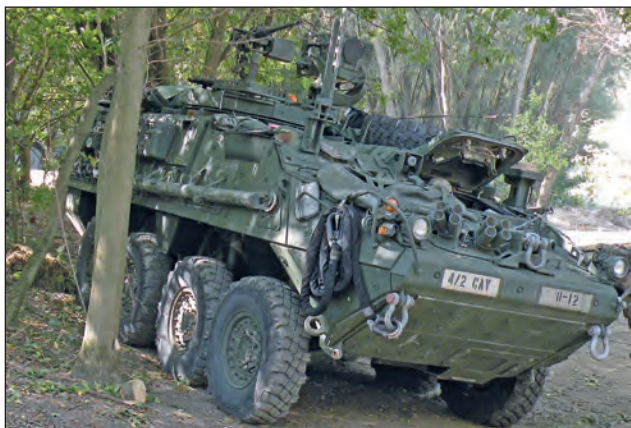
7. ábra. Az M1127-es orrán további ködgránátvetők, valamint vontatáshoz szükséges eszközök láthatók
