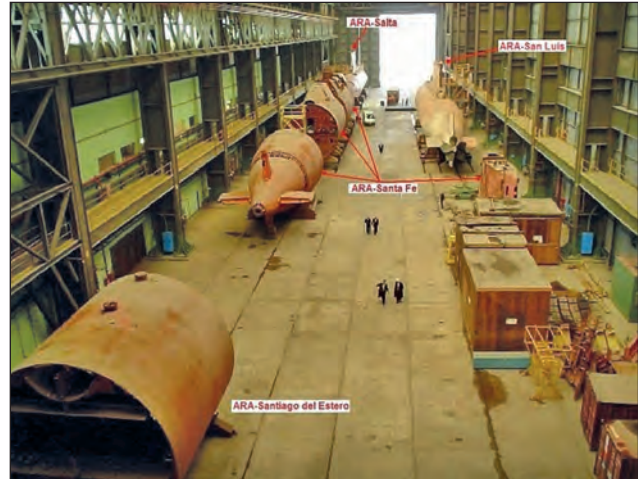
17. ábra. A két felújítás alatt álló Type 209-es és a félbeahagyott TR 1700-as típusú tengeralattjárók fődarabjai a tandanori hajógyárban
