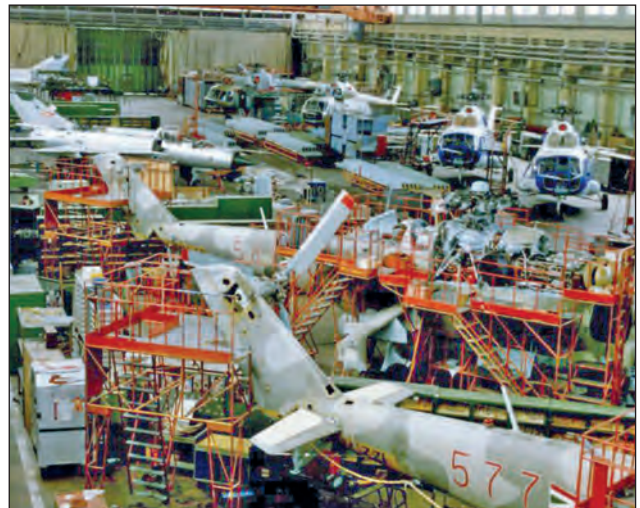
4. ábra. A tervszerű megelőző javítás egy példája. A Mi helikopterek és MiG vadászgépek ipari nagyjavítása a tőkili Pestvidéki Gépgyárban az 1990-es évek elején
