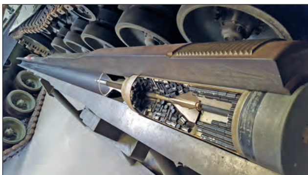
10. ábra. Egy különleges perspektívából készült kép a Leopard 2-es fő fegyverzetéről, a Rheinmetall Rh 120 sima csövű ágyúról. Érdemes megfigyelni a csőfalat és a betöltött ürméret alatti páncéltörő löszert, illetve a lövedékben az ürméret alatti „nyíllövedéket”
