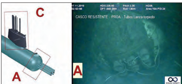
22. ábra. A roncsok elhelyezkedéséből rekonstruált számítógépes grafikán látható, hogy a torony, a torpedóvetőcsöveket rejtő áramvonalas burkolattal együtt leszakadt a hajótestről. Utóbbi részlet látható a roncsról készült vízalatti felvételen is
