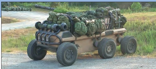
6. ábra. A MULE XM1217 szállító robotjármű, amely sérültek mentésére is alkalmas
