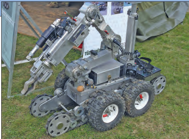
1. ábra. A Magyar Honvédség tűzszerész felderítő robotja manipulátor karral. Fő feladatai: a katonai eredetű és improvizált robbanótestek hatástalanítása, valamint a tűzszerész felderítési tevékenység biztosítása (Fotó: Dr. Hegedűs Ernő)
