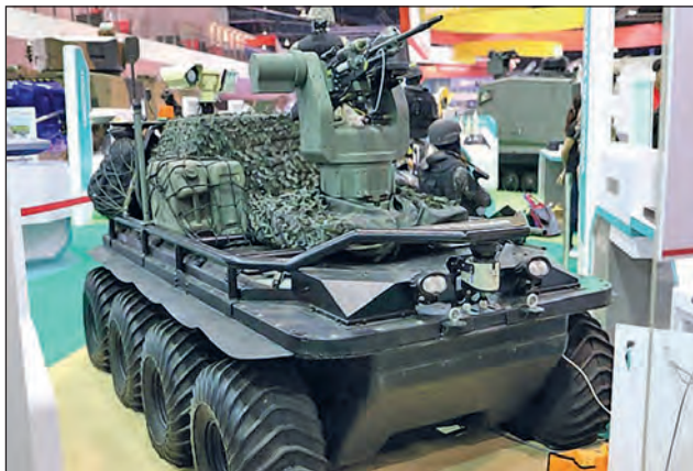
7. ábra. A kerekes futóművű, dízel-elektromos hibrid meghajtású Jaeger 8 UGV harcjármű kételtű
