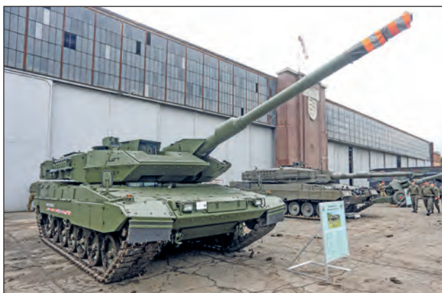
5. ábra. A Leopard 2 harckocsicsalád legújabb, legkorszerűbb változata az A7+ verzió. Érdeemes megfigyelni a főfegyverzetet, a maximális állásszögre emelt 120 mm-es sima csövű löveget, amely végét ekkor még takaróponyvával fedtek az időjárás viszontagságai miatt (Fotó: HM Zrínyi Kft. Dévényi Veronika)
