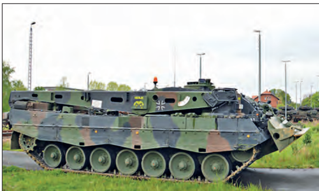
18. ábra. Leopard 2-es műszaki mentő változata, a harcjárművel azonos alvázon
