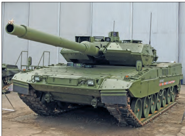
1. ábra. A Leopard 2A7+ harckocsi kategóriájában a világ egyik legkorszerűbb eszköze. Rendszerezésével a Magyar Honvédség harckocsizói olyan új képességekhez jutnak mint a körkörösen megerősített páncélzat és a teljes lefedettségű éjjel-nappali kilátás (Fotó: HM Zrínyi Kft. Dévényi Veronika)
