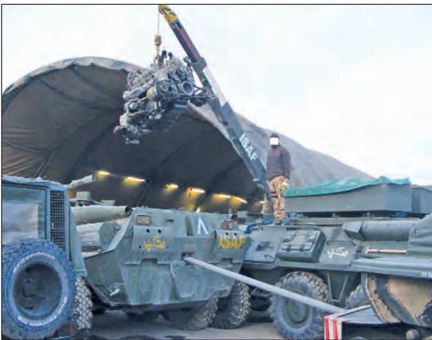
11. ábra. A katonai járművek igénybevétele békeidőben általában kisebb, mint a polgári eszközöké, minősített időszakban viszont az üzemeltetés mértéke akár nagyságrenddel is megnövekedhet. A képen BTR 80A motorcseréje látható tábori körülmények között
