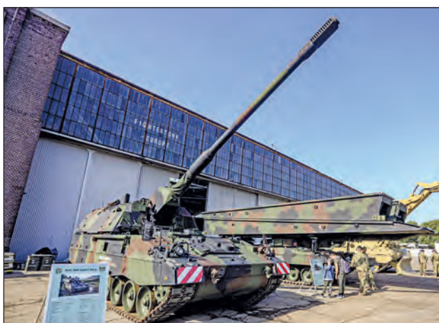
6. ábra. A PzH 2000 önjáró löveggel, a világ élvonalába tartozó fegyverrel a honvédségben újra megjelenik az önjáró tüzérség. A PzH 2000 digitális löelemképző rendszerével „sebészi pontosságú” tűzcsapást mérhet, akár 30 km-es távolságban felderített célokra is (Fotó: HM Zrínyi Kft. Dévényi Veronika)
