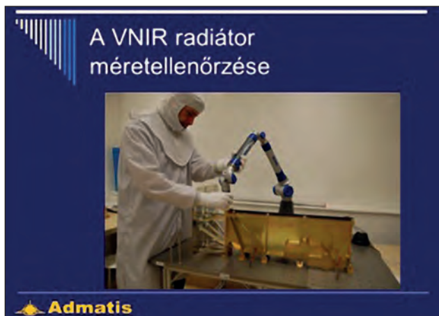
3. ábra. A VNIR FEEM radiátor méretellenőrzése az ADMATIS tisztaszobájában
