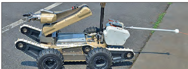
8. ábra. Az Andros Titus manipulátor-karral felszerelt UGV jármű futóműve kombinált kerekes-lánctalpas kialakítású
