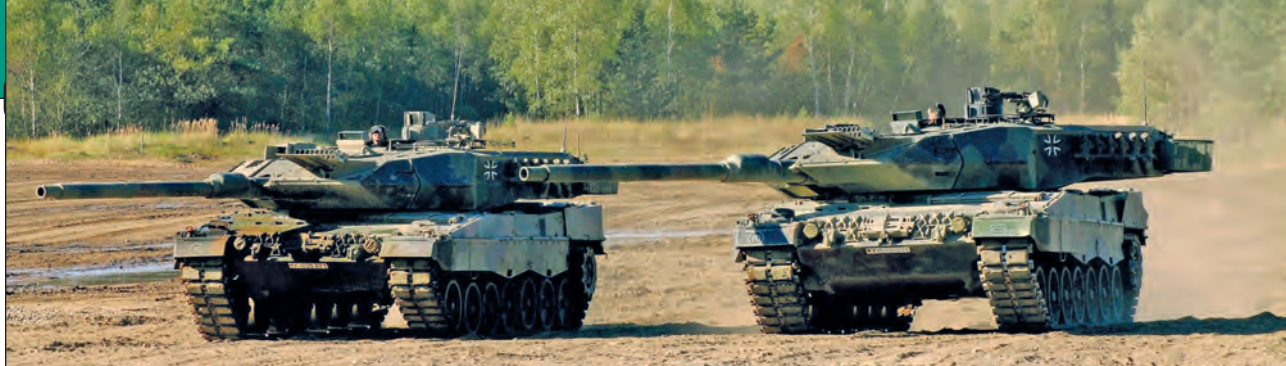
16. ábra. Bundeswehr két Leopard 2A6 típusú harckocsija egy hadgyakorlaton vonul. Jól megfigyelhetők azok a külső jegyek, amelyek megkülönböztetik az A4-es alapváltozatot az előszériától. (Pl. a hosszabb L/55 kaliberű löveg, vagy a szögletes toronyot felváltó „nyílhegy”, illetve az ék alakú előtépáncélzat. Utóbbi már az A5-ös változatokon megjelent)
