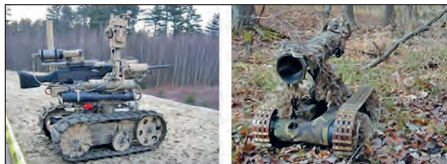
3. ábra. A SWORD harci robot. A telepített fegyverzet variálható: balra géppuska, jobbra páncéltörő rakéta
