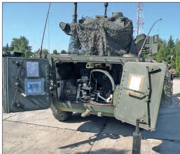
12. ábra. M1128-as tűztámogató hátsó nyílásai nyitott helyzetben, a nagy méretű ajtók segítik a lövészek gyors be- és kiszállítását, a muníció könnyebb bemálházását
