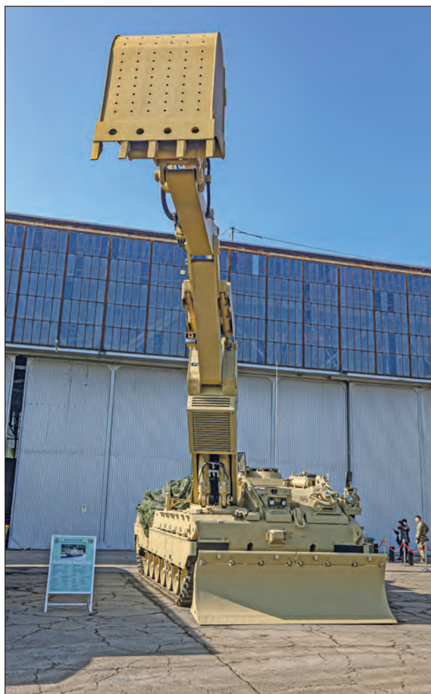
8. ábra. A Wisent 2-es nehéz műszaki mentő és akadályelhárító jármű kinyújtott markoló kanállal. A Leopard 2-es harckocsi alvázára épített jármű követi azt a páncélosok tervezésében elfogadott „családelvet”, amely szerint az műszaki járműveket a harckocsikkal azonos alvázra kell telepíteni, hogy ezáltal ugyanolyan mozgékonyak lehessenek, és együtt haladva támogathassák a hadműveleteket (Fotó: HM Zrínyi Kft. Dévényi Veronika)
