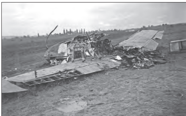
8. ábra. A Bf 109-es orra és szárnyai, elválasztva a gép többi részétől
