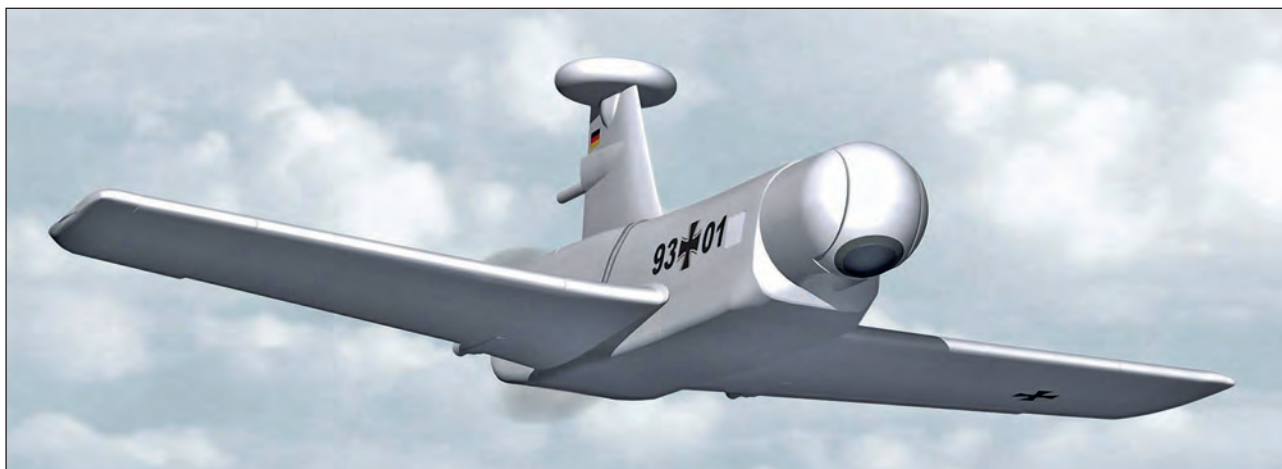
1. ábra. A KZO rendszer 168 kg felszálló tömegű, pilóta nélküli felderítő repülőgépe
