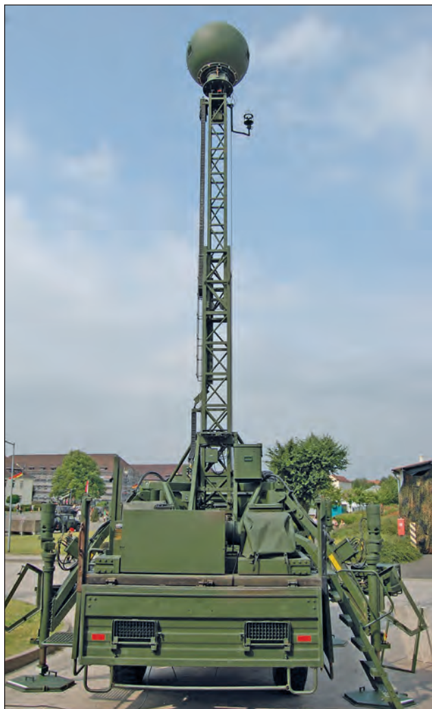
5. ábra. MAN adatkapcsolati jármű 11 méteres antennaárbóccal és mikrohullámú sugárzóval
