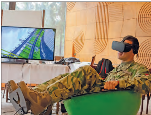
5. ábra. Yaw VR mozgásszimulátor, szemüveggel. A berendezés komplex mozgásformák élethű szimulációjára képes (Fotó: M. B.)
