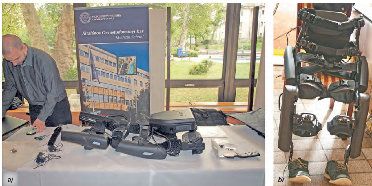
9. ábra. Pécsi Tudományegyetem Általános Orvostudományi Kar által kiállított ReWalk P 6.0. típusú exoskeleton összezsukva, valamint beüzemelve (Fotók: Sz. A., M. B.)
