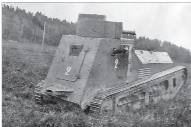
19. ábra. Az LK II / Strv m/21 két oldalán, valamint elöl a vezető mellett és hátul a búvónyíláson/ajtón kialakított, páncélzattal lezárható nyílásokba összesen akár 4 darab további géppuskát is el lehetett helyezni gyalogság elleni másodlagos fegyverzetként. A gyakorlatban általában 1, maximum 2 darabnál többet nem szereltek be, s gyakran teljesen mellőzték is ezeket a további géppuskákat. A képen a 2-es számú Strv m/21-es látható, oldalsó kiegészítő géppuskával is ellátva
