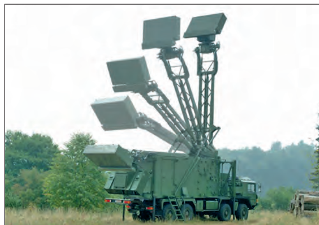
3. ábra. A TRML-3D radar antennarendszerének telepítése
