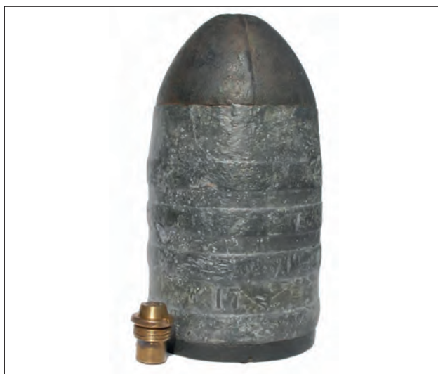
8. ábra. A 15 cm-es 1861/1M gránát és gyújtószerkezete
