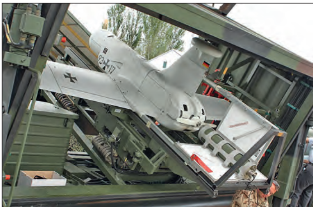
3. ábra. Drón az indítókonténerben
