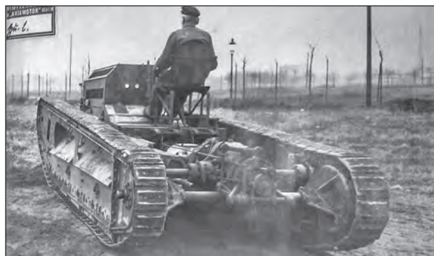
12. ábra. A Steffen & Heymann által felajánlott „lánctalpas nehéz vontató” fényképe, amelyet az 1921. márciusi ajánlattételükhöz is csatoltak. A képen könnyen felismerhető a páncélborítás és felépítmény nélküli LK II alváza
