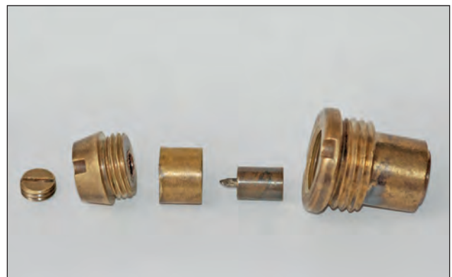
7. ábra. Az 1901M gránát gyújtószerkezetének alkatrészei a biztosító lemez és a csappantyú nélkül
