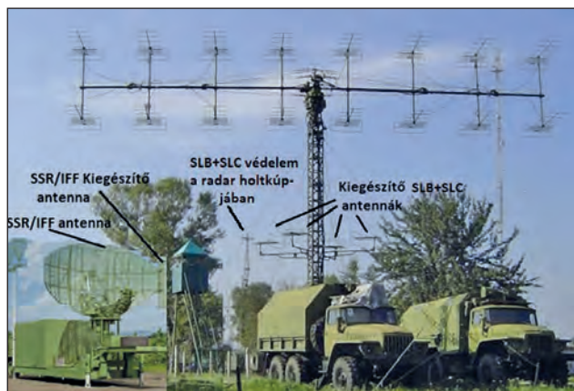
5. ábra. Ukránok által modernizált P-18/2000 VHF radarmérőpont
