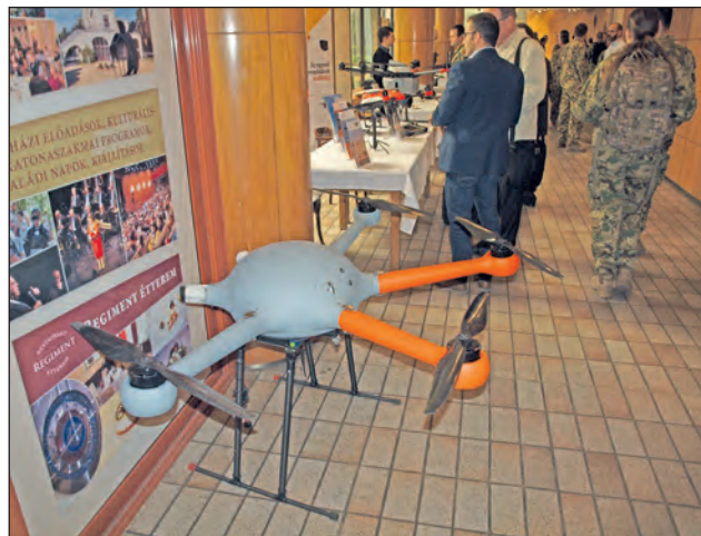
7. ábra. Hazai fejlesztésű, GigaRotor-6 típusjelzésű villamos hajtású helikopter-UAV (a két hátsó rotortartó konzol leszerelt állapotban van) (Fotó: Sz. A.)
