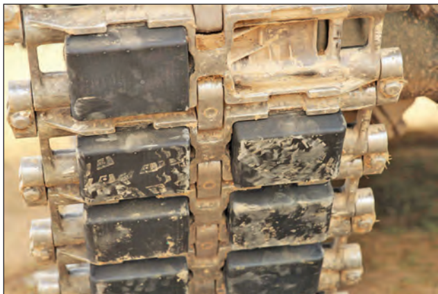
7. ábra. Egy Afganisztánban bevetett dán Leopard 2 A5 DK jelzésű harckocsi, a Diehl által gyártott láncfalpának részlete. Jól megfigyelhetők a gumibetétek, amelyek közül egy hiányzik
