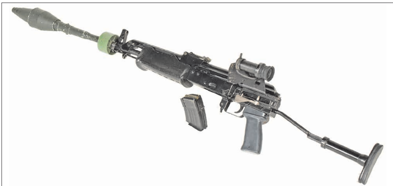
18. ábra. AMP puskagránátlövő gépkarabély PGK puskagránáttal, és kilövőtölténnyel töltött 6-os tárral
