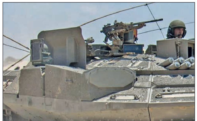
9. ábra. Merkava IV-es lövegtoronyára szerelt Trophy páncélvédelmi rendszer közeli képe. Balra fent a repesztöltet-kivető egység, középen a négy radarantenna egyike
