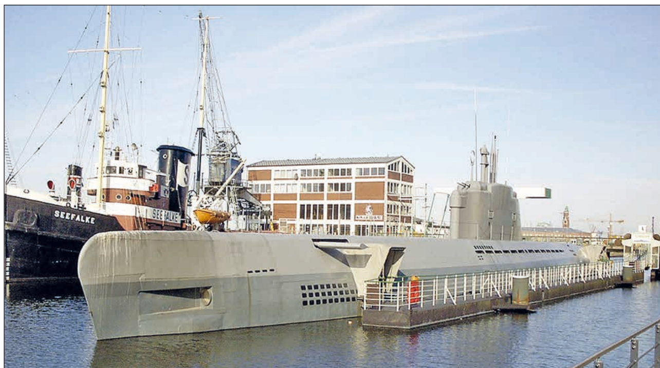
28. ábra. Egy korszerűbb német második világháborús tengeralattjáró. A XXI. osztályú WILHELM BAUER ex. U 2540-es, technikai múzeumként Bremerhaven kikötőjében látogatható. A XXI. osztályú electro-boot-ok jóval nagyobb víz alatti sebességükkel, gépi vezérlésű torpedóvető csövekkel a későbbi amerikai és szovjet tengeralattjárók mintájaként is szolgáltak
