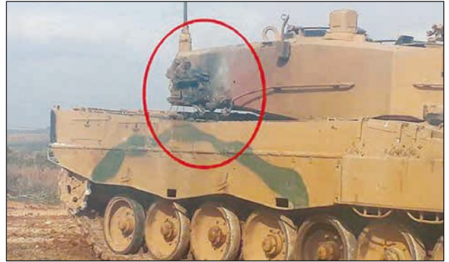
7. ábra. Ezt a kiegészítő páncélvédelem nélküli Leopard 2-est a torony hátsó részén érte a rakétatalálat, de kisebb sérüléssel működőképés maradt
