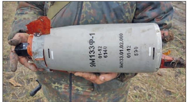
8. ábra. Termobárikus robbanófejjel szerelt, fel nem robbant Kornet rakéta
