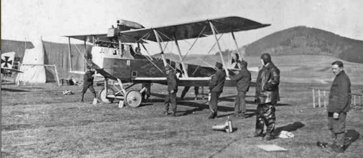
6. ábra. Motorpróba a Flik 39/D egyik Hansa-Brandenburg C.I-es felderítőgépén
