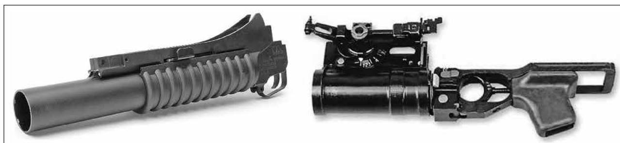
17. ábra. M203-as (balra) és GP-25-ös (jobbra) cső alatti gránátvetők. (Nem méretarányos)
