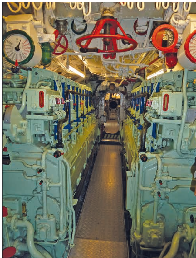
24. ábra. Az U 995-ös gépterme a két dízelmotorral. A dízelmotorjai 665 kW (kb. 905 LE-s) teljesítményt adtak le
