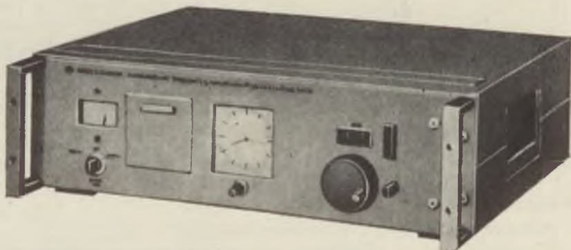
35. ábra. A Rhodé és Schwarz-cég kis kvarcórája, melyhez hasonlók a MTA Csillagvizsgáló Intézetében is működnek
