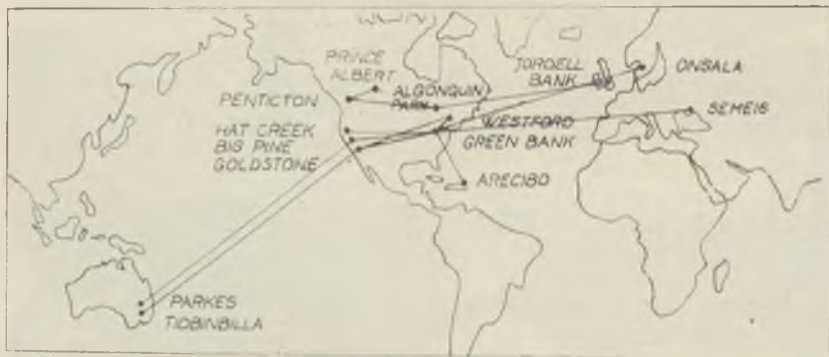
23. ábra. A kvazárok és galaxismaagok szerkezetének tanulmányozásához végzett VLBI kísérletek a fenti állomások bevonásával történtek. Az állomásokat összekötő vonalak a bázisvonalakat jelképezik
