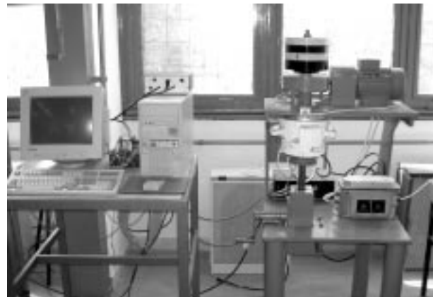
1. ábra: Univerzális Hardgrove-malom és szabályozó-, mérésadatgyűjtő rendszere [4]
