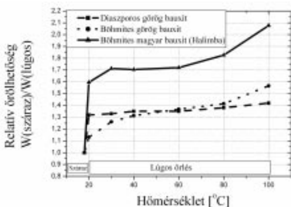
8. ábra: Relatív őrlhetőség hőmérséklet függése CaO adalékanyag alkalmazása mellett [6]
