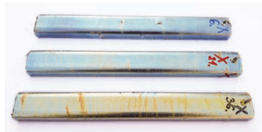
2. ábra. A 80 × 100 × 0,8 mm méretű acéllemezek (balra) és 30 × 15 × 2 × 250 mm méretű U profilok (jobbra) növekvő mangántartalmú horganyfürdőben horganyozva
