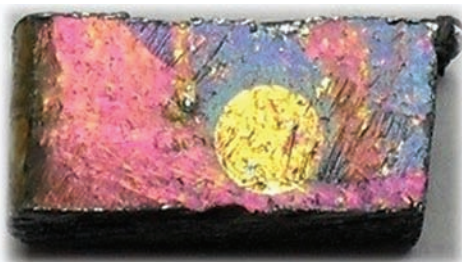
7. ábra. Az SNMS-sel 70 másodpercig (balra) és 140 másodpercig (jobbra) porlasztott minták (0,2 m/m% Mn-tartalom, 50 × 50 × 5 mm-es szögacél minta)
