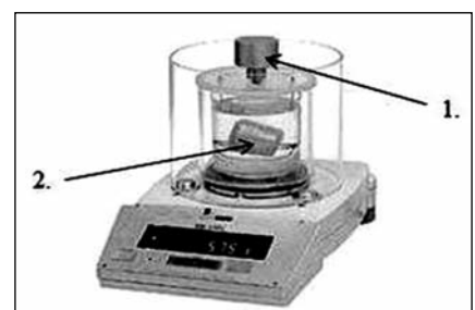
■ 1. ábra. Sűrűségméréshez használt „MK 2200” típusú precíziós mérleg [1]. 1. A mérleg tárgyasztala, 2. Desztillált vízben elhelyezett próbatároló-kosár
