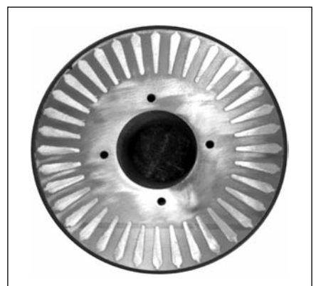
■ 6. ábra. Egyenletes nűtöltéssel öntött réz (bal) és alumínium (jobb) rotor. A nűtok porózitásmentesek (a rotorok a szabadalmaztatott Breuckmann öntési technológiával készültek)
