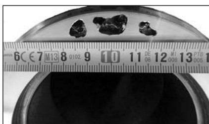
■ 9. ábra. A kivágáshoz használt kenőanyag okozta porozitás a rézzel kiöntött indukciós motor zárógyűrűjében
