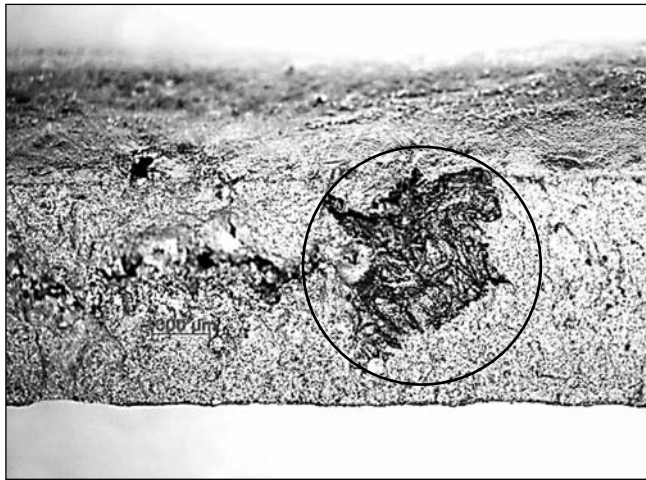
■ 6. ábra. K-próba szennyezett töretfelülete sztereomikroszkópon
