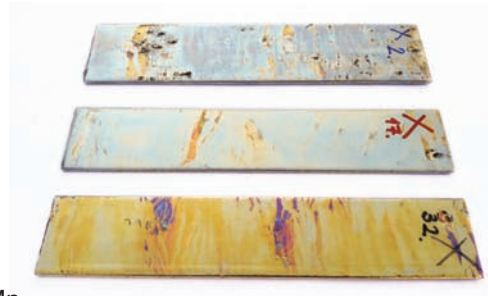
3. ábra. A 40 × 40 × 3 × 250 mm méretű zártszelvények (balra) és az 54 × 250 × 4 mm méretű laposacélok (jobbra) növekvő mangántartalmú horganyfürdőben horganyozva
