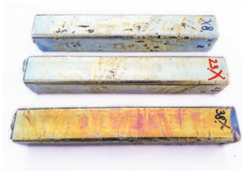
3. ábra. A 40 × 40 × 3 × 250 mm méretű zártszelvények (balra) és az 54 × 250 × 4 mm méretű laposacélok (jobbra) növekvő mangántartalmú horganyfürdőben horganyozva
