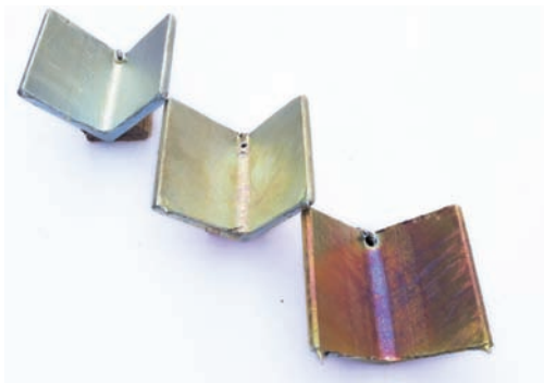
4. ábra. Az 50 × 50 × 5 × 60 mm méretű szögacélok (balra) és az 50 × 10 × 250 mm méretű lapos acélok (jobbra) növekvő mangántartalmú horganyfürdőben horganyozva
