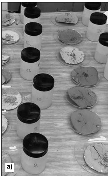
■ 5. ábra. A konvertersalakok alapvető laboratóriumi kioldási kísérletei (a, b – oldatok és maradványok, c – gázfejlődés a rázódoboz nyitásakor)
