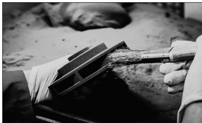
■ 5. ábra. Járókerék nyomtatás utáni tisztítása
