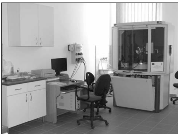
■ 2. ábra. Bruker D8 Discover diffraktométer Euler-bölcsovel
