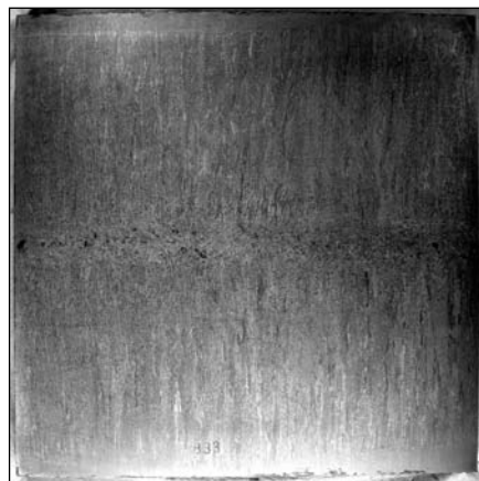
■ 2. ábra. Folyamatosan öntött OFHC-réz és szerkezeti acél lapos bugájának keresztmetszetéről maratott állapotban készített felvétel
