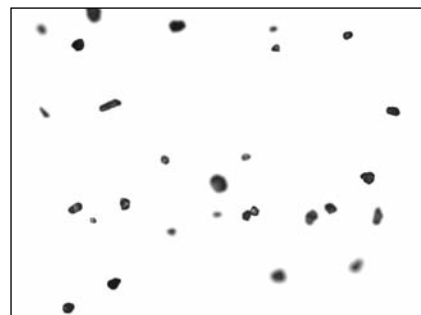
7. ábra. Az SH 34-es homokminta dinamikus képelemzés során készített felvétele
