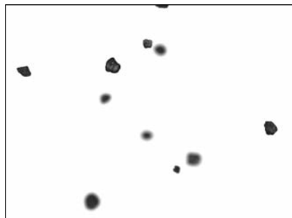
6. ábra. A H32-es homokminta dinamikus képelemzés során készített felvétele
