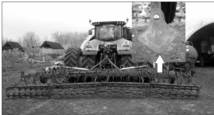
■ 4. ábra. A lúdtalpkapákkal felszerelt munkagép, és egy kapa kinagyítva
