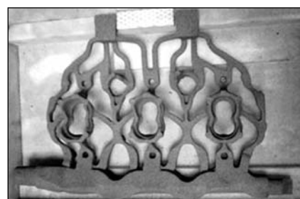
1. ábra. Egy hengerfej üregeinek kialakításához használt bonyolult geometriájú mag
