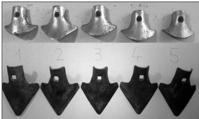
■ 5. ábra. A kísérleti darabok használat előtt (alsó sor) és használat után (felső sor)
