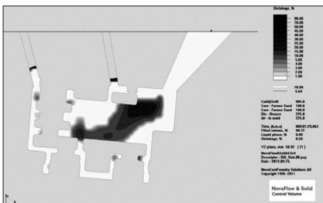
■ 5a ábra. Az elválasztó fal dermedése
