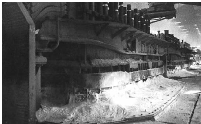
■ 2. ábra. Felsőtűskés Söderberg-technológia átalakítás előtt
