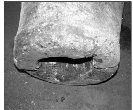
■ 2. ábra. A II. sz. nagyolvasztó sérült fúvóformája a formaerózió hatására
