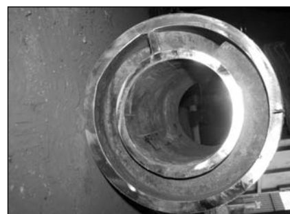
■ 3. ábra. A sérült fúvóforma és a kivágott orr-rész elemzésre kijelölt pozíciói
