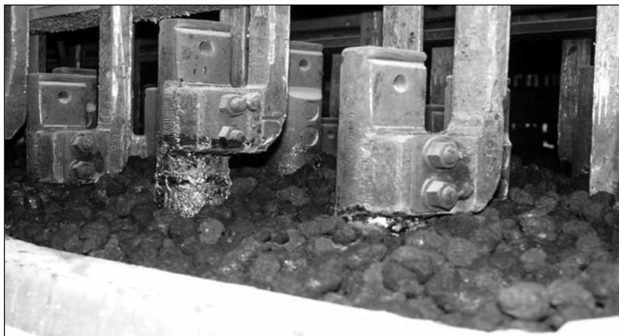
■ 1. ábra. Szilárd anódtető a benz(a)pirén kohócsarnoki légtérbe kerülésének csökkentésére
