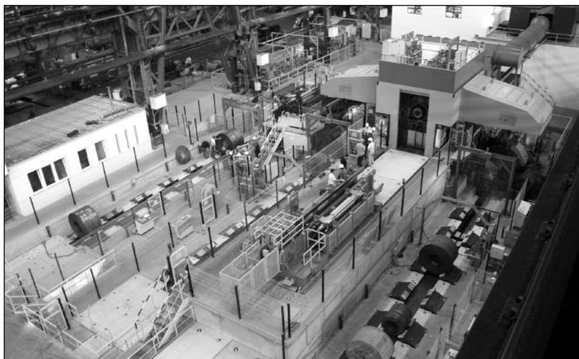
1. ábra. Az ISD Dunafer Zrt. új, reverzáló hidegen hengerrőlő hengerállványa
