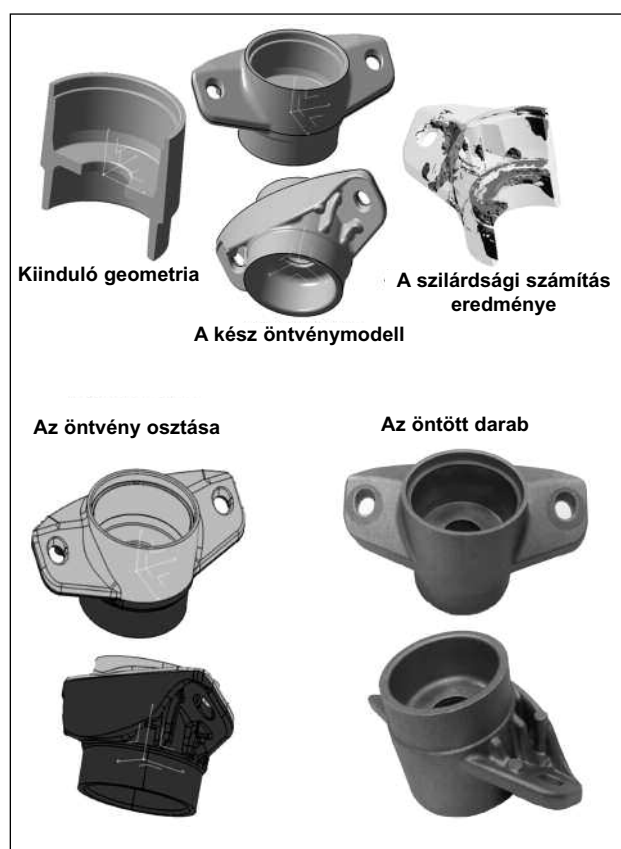
■ 4. ábra. Csapágycsillapító elem öntvényének fejlesztése
