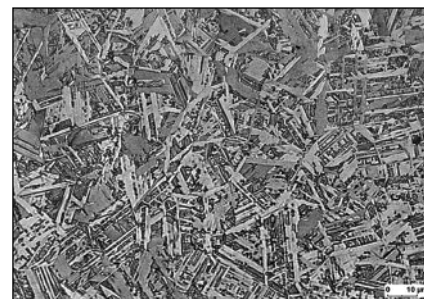
■ 2. ábra. Az 1. acél kiinduló szövetszerkezete: ausztenit és \epsilon -martenzit fázis
