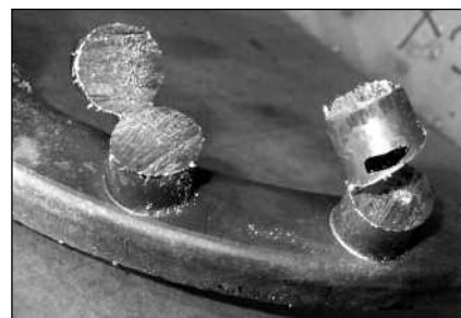
■ 9. ábra. Kilevegőző betétek alkalmazásával öntött öntvények elvágott kiegyenlítő csapjai
