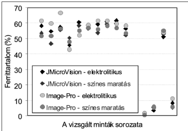
■ 7. ábra. Duplex és ausztenites acél alapanyagok azonos szövetszerkezeti képein kétféle képelemzővel meghatározott ferrittartalmak
