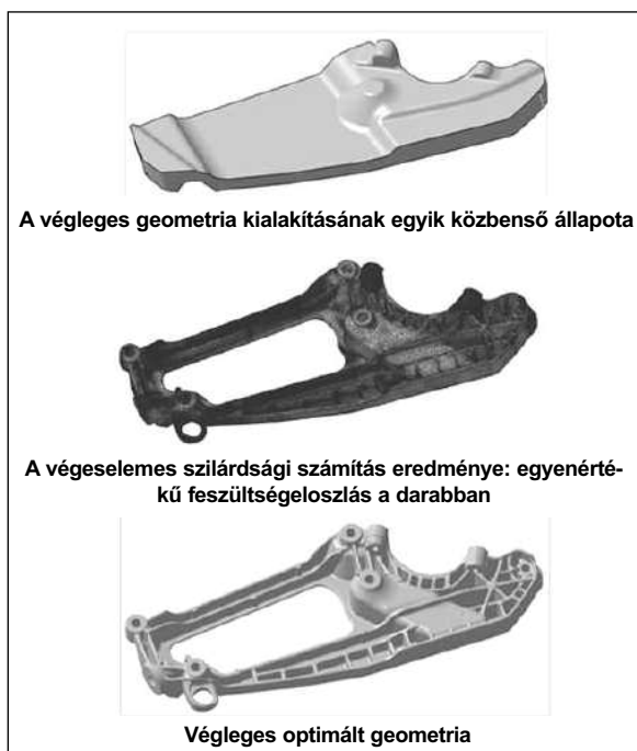
■ 7. ábra. A fejlesztési munka lépcsői egy alumínium-öntvényből készült autómotor felfüggesztő elemnél
