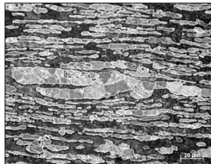
■ 4. ábra. LDX2101 (szabványos jele: 1.4162) duplex acél szövetszerkezete színtuttató maratás után
