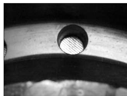
■ 5. ábra. Az öntőszerszámába beépített levegőztető betét
