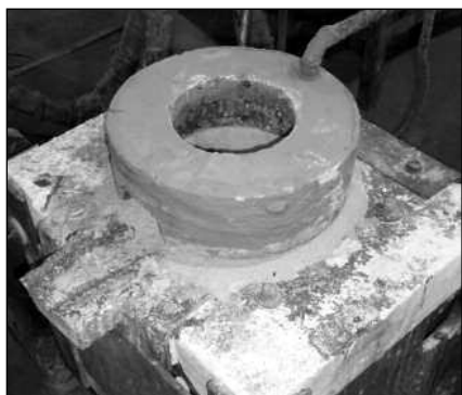
■ 1. ábra. Örvénylő argongáz bevezetése a kemence tetejére helyezett kerámia-gyűrűn keresztül
