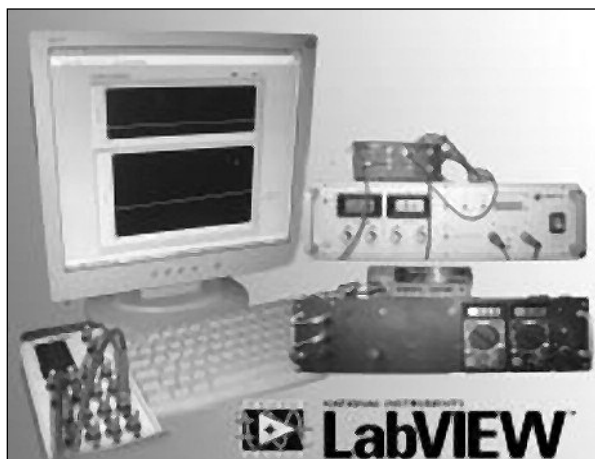
■ 2. ábra. A számítógépes adatgyűjtő-áramvezérlő rendszer kialakítása
