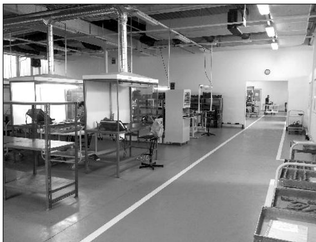
■ 1. kép. Az új viaszpréseknél füstelszívót és egyéni megvilágítást építettek be
