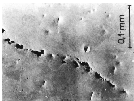
10. ábra. Al-mal túldeoxidált acél tipikus rideg \text{Al}_2\text{O}_3 zárványa (VKI)
