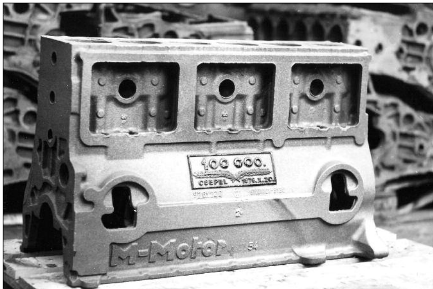
■ 13. ábra. A 100 000. MAN-forgattyúházöntvény
