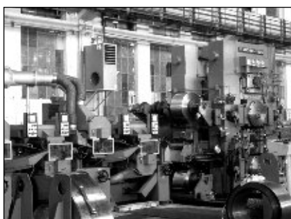
■ 12. ábra. A hidegplattírozó hengerállvány
