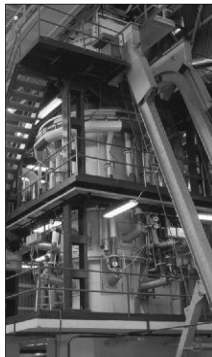
■ 6. ábra. Az új rézfinomító: aknás kemence
