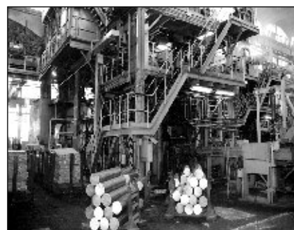
■ 7. ábra. Az OFHC folyamatos tuskóöntő-berendezés
