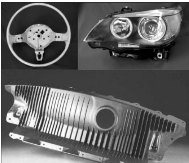
4. kép. SMART-kormány AM60-ból, BMW-reflektor AZ91-ből és SLK üzemanyagtartály-fedél AM50-ből
