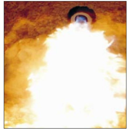
8. ábra. Hagyományos és oxyfuel égő lángképe (szűrőláng)
