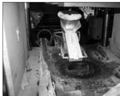
■ 19. ábra. Az SSM-iszapok előállítására szolgáló, továbbfejlesztett, vízszintes (balra) és függőleges (jobbra) nyomásos-öntőgépre szerelt CRP™ reaktorok tipikus elrendezése
