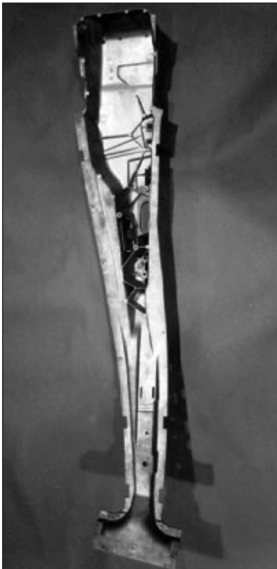
■ 6a ábra. Nagy vákuumban öntött „B”-oszlop
