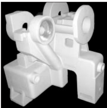
■ 8. ábra. Háromfokozatú kompresszorház, ASTM 536 60-40-18, 1525 kg
