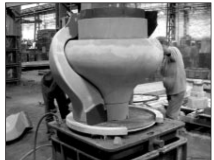
■ 11. ábra. Vezetőlapátház magcsomagjának összeállítása sablonban, EN-GJL 250, 2350 kg
