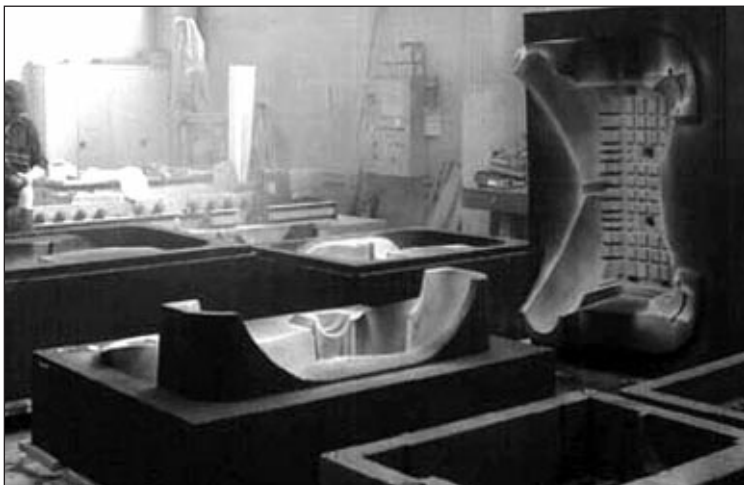
4. ábra. Kisnyomású kemence felhasználásával, pontos homokformába öntött, tömör alumínium alkatrész
