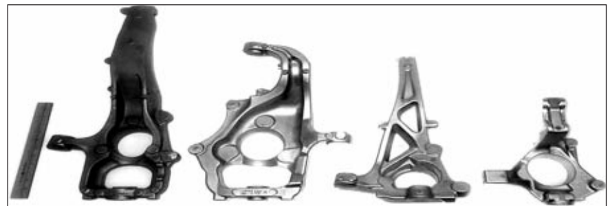
■ 3c ábra. A PCPC-eljárással gyártott szerkezeti gépkocsiöntvények példái, a mérettartomány: 2,5–7,0 kg (Internet-fotó)
