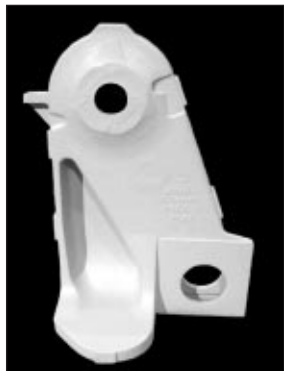
■ 5. ábra. Láncvezető villa kikötői konténer- osztályozó daruhoz, EN-GJS-500-7, 680 kg, 9 részben röntgenvizsgálatra kötelezett
