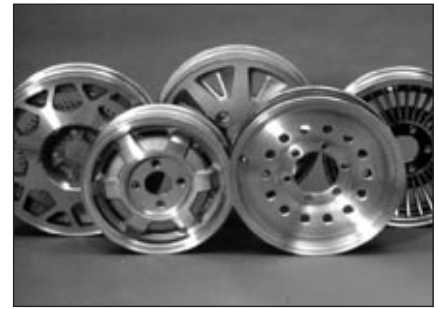
■ 1b ábra. Kisnyomású kokillaöntéssel (LPPM) gyártott alumíniumkerekek (keréktárcsák)
