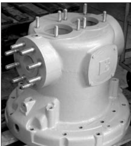
■ 3. ábra. Készre munkált, nyomáspróbán át- esett kompresszorhenger, EN-GJL-250, 560 kg, 48 bar üzemi nyomás
