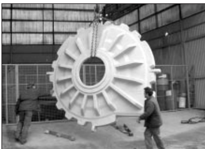
■ 4. ábra. Zagyszivattyúfél, EN-GJS-600-3, 9800 kg
