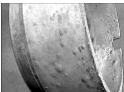
5. ábra. Hólyagok egy oldó hőkezelési HPDC-öntvényen
