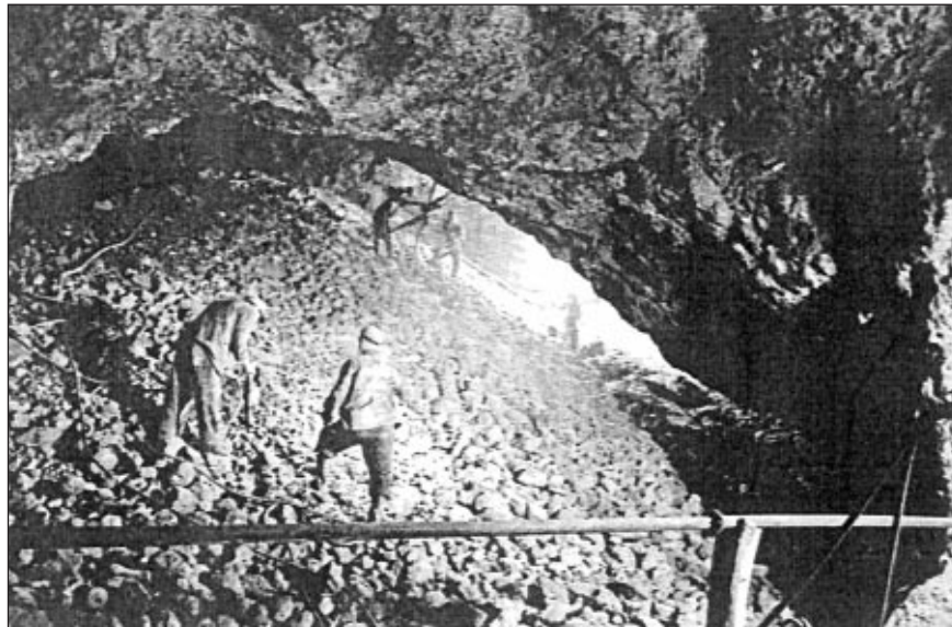
■ 5. ábra. Értárolásos, ún. magazinfejtés a Lahóca hegyi bányában
