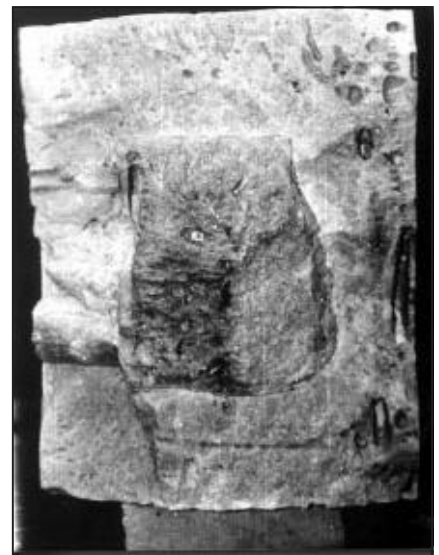
■ 1. kép. A fénykép egy, a szerző által említett, kettétört, „betétes” kádkő keresztmetszetét mutatja
