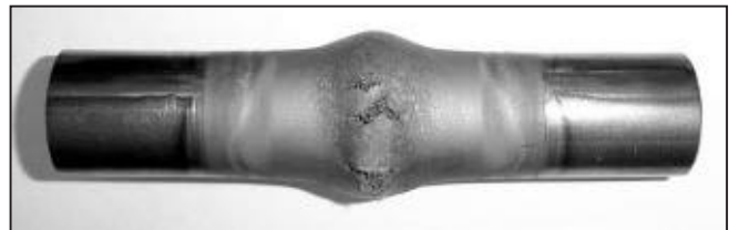
10. ábra. 25,4 mm átmérőjű próbatesszt a SICO-teszt elvégzése után
