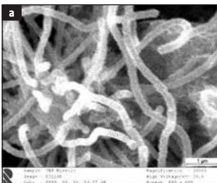
■ 6. ábra Különböző sóolvadékokban keletkezett szén nanocsövek SEM képei a: Ca2, b: Li2, c: Na5
