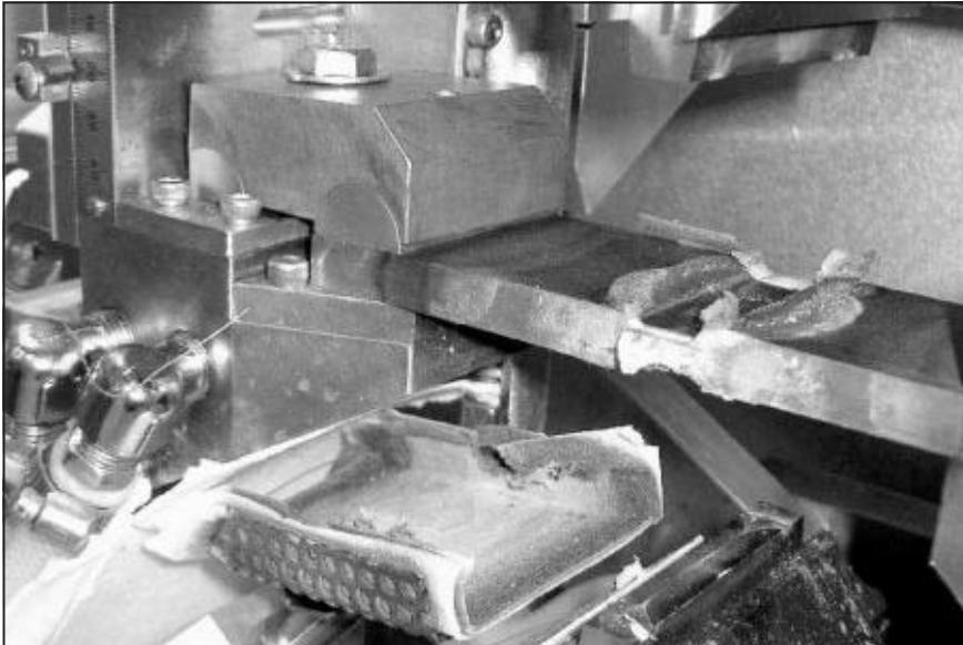
■ 5. ábra. A próbatess alakja a HDS-V40 berendezésen végzett szimuláció után. A tégely hátra-húzása után válik lehetővé az alakítás, illetve a próbatess kivétele
