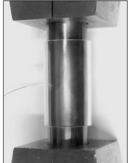
■ 6. ábra. 1 inch, azaz 25,4 mm átmérőjű próbatess kvarctégellyel. A tégely tartja meg az olvadékokat a megolvasztás majd lehűtés közben
