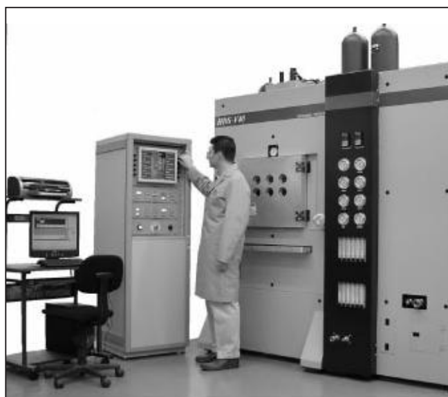
1. ábra. A HDS-V40 fizikai szimulátor
