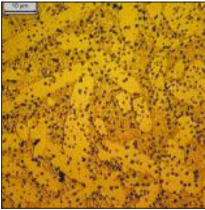
■ 17. ábra. Al-bronz szövete képe (e.n.: 1000×, 10%-os vizes ammónium-perszulfát)
