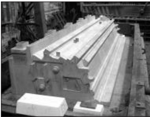
■ 4. ábra. A beottítómb elhelyezése és a reakciókamra kialakítása a formázás során
