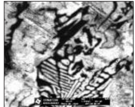
2. kép. A Nihard-4 minőségű fehérvasban levő korallszerű karbidokról készült elektronmikroszkópos felvétel. A háttérben masszív karbid. Eredeti nagyítás 2500×
