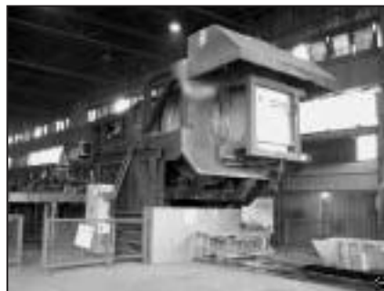
■ Az Alu-Block Kft. nyolc tonnás, forgódobos olvasztókemencéje
