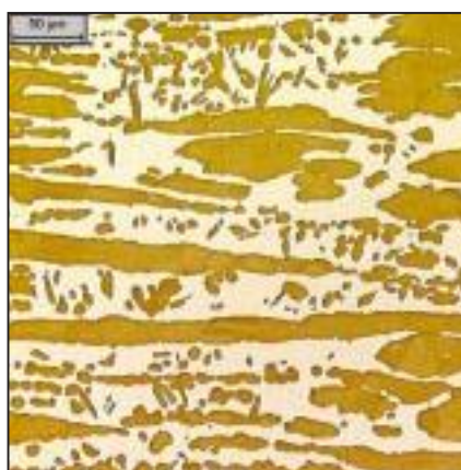
■ 29. ábra. Duplex acél szövete képe (eredeti nagyítás: 200×, 11. reagens)
