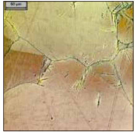
■ 22. ábra. Hadfield-acél szövete képe (eredeti nagyítás: 200×, 2%-os Nital)
