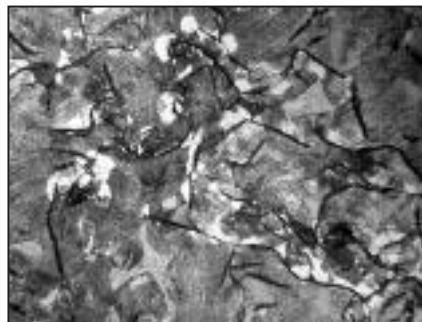
■ 7.a ábra. Elsődleges beoltás Nitallal maratott csiszolat, N = 500×
