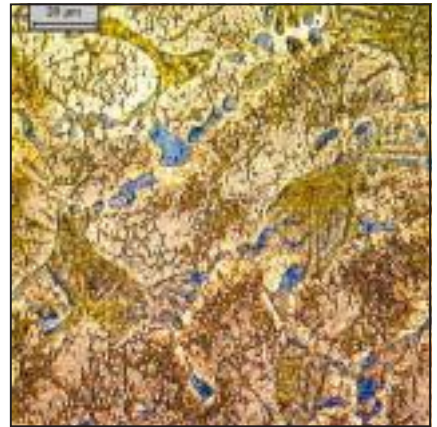
14. ábra . AlMgSi ötvözet szövetképe (eredeti nagyítás: 500×, 8. reagens)
