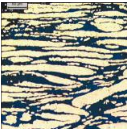
■ 27. ábra. Duplex acél szövete képe (eredeti nagyítás: 200×, 10. reagens)
