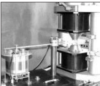
■ 1. ábra. A PMVSM-berendezés rezgető egysége, rezgő mintatartó rúdja és elektromágnes
