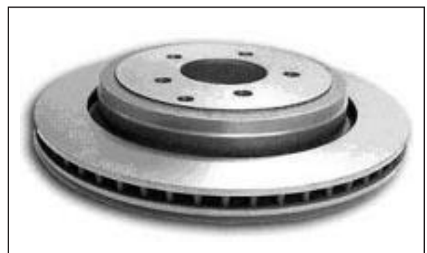
■ 3. ábra. 359/SiC/20p kompozitból készült féktárcsa [4]
