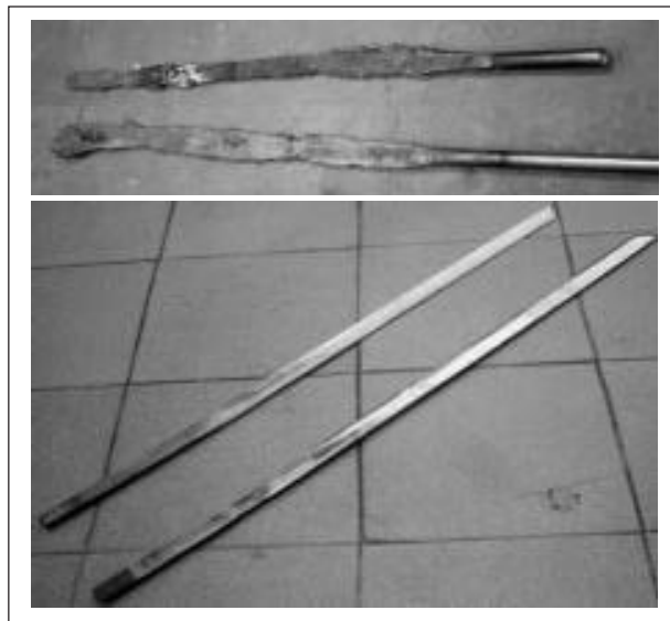
■ 4. ábra. Damaszkolt kardpengék a kovácsolás után és készremunkálva, a maratás előtt
