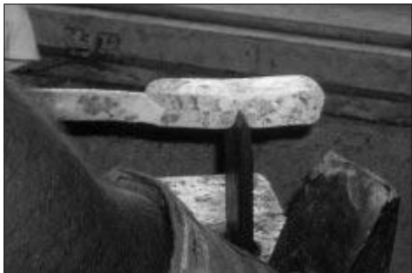
■ 2. ábra. A damaszkolás hajtási műveletét megelőző bevágás
