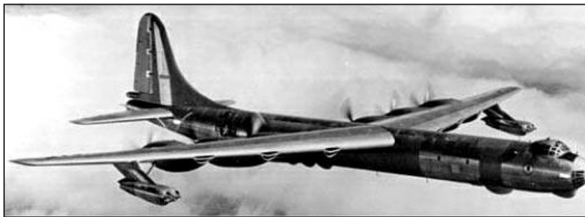
■ 10. ábra. A 10 tonna Mg-t tartalmazó Convair B-36 repülőgép
