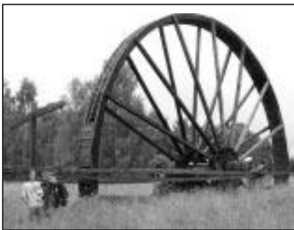
■ 4. ábra. Polhem által szerkesztett, rekonstruált vízikerek
