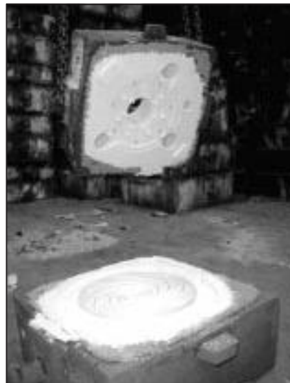
■ 3. ábra. A Královopolskánál nagy járókeréket öntöttek kombinált technológiával. A Unicast-magot Unicast-kerámiával burkolt samott formába helyezték. A kombinált technológia precíz belső felület és nagyon sima külső felület kialakítását tette lehetővé, minimális mennyiségű kerámiát használva. Az elkészült járókeréköntvény 300 mm átmérőjű és a hidraulikus kiömlőnyílásai 6 mm-esek.
