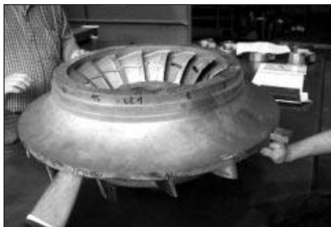
■ 5. ábra. A Královopolskánál öntött, nagy Francis-turbina forgórész. A Unicast-eljárás lehetővé teszi, hogy a precíziós öntést a viaszmintás öntéssel készíthetőknél jóval nagyobb alkatrészek esetén is alkalmazzák. Nem használnak viaszt, sem viaszajtoló szerszámokat, így az öntőde a gyártási folyamat minden aspektusát ellenőrizheti és sokkal rövidebb idő alatt készítheti el a nagy precíziós öntvényeket.
