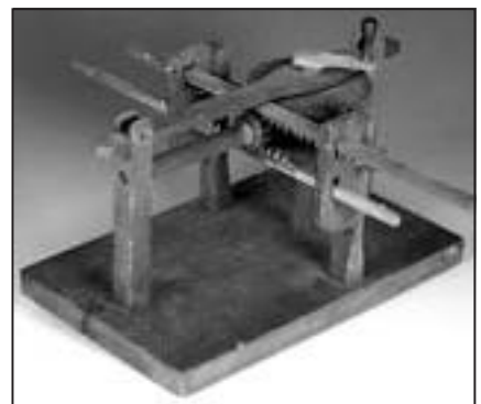
■ 13. ábra. Forgómozgást alternáló mozgássá átalakító szerkezet Polhem mechanikai ABC-jéből
