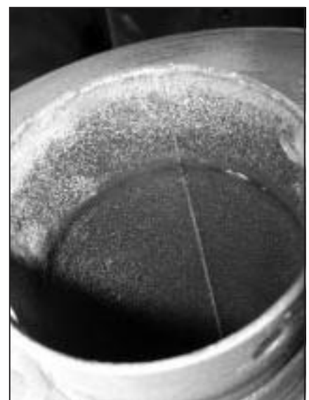
■ 6. ábra. Ellenállás-hegesztéssel készült hosszvarrat
