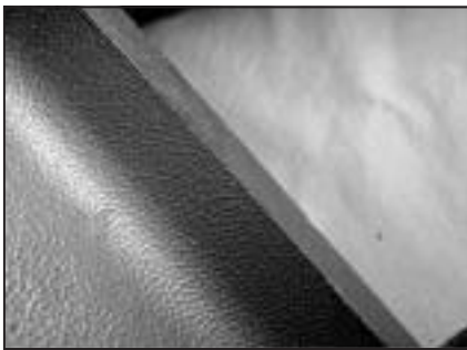
■ 8. ábra. Élethű bőrrajzolat acélszerszámban. A képen látható darab kerámiaformájának előállításához valódi bőrt használtak. Az üreget nem szükséges megmunkálni.
