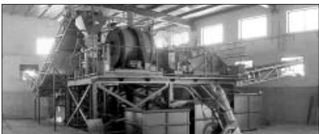
■ 4. ÁBRA. Sorba kötött kétlépcsős flotálóberendezés
