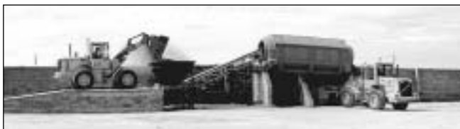
■ 3. ÁBRA. Az aprított vegyes alumíniumhulladékot osztályozó dobszita
