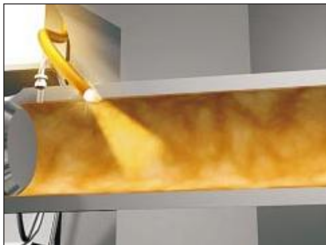
■ 5. ábra. Gőz halmazállapotú leválasztóanyag bevitele a lövőkamrába porlasztással
