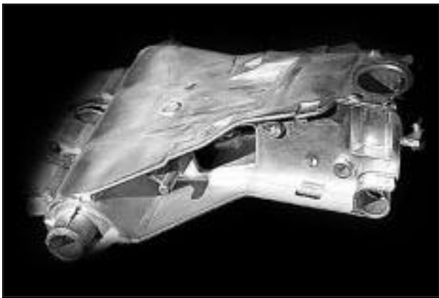
■ 3. ábra. Széktartó nyomásos öntvény kb. 130.000 lövés után. A szerszámot nem szórták vizes alapú leválasztóanyaggal. A HA-Trennsol-eljárást sűrített levegővel alkalmazták
