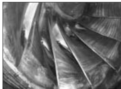
5. ábra. A hegesztett járókerék részlete
