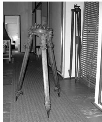
4. ábra: Cséti-féle bányászati műszerállvány
