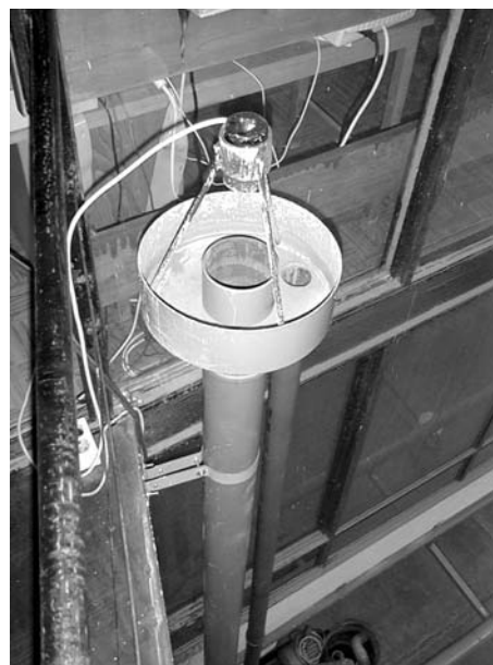
4. ábra: Fényképek a süllyedési végsebességmérő kísérleti berendezésről
