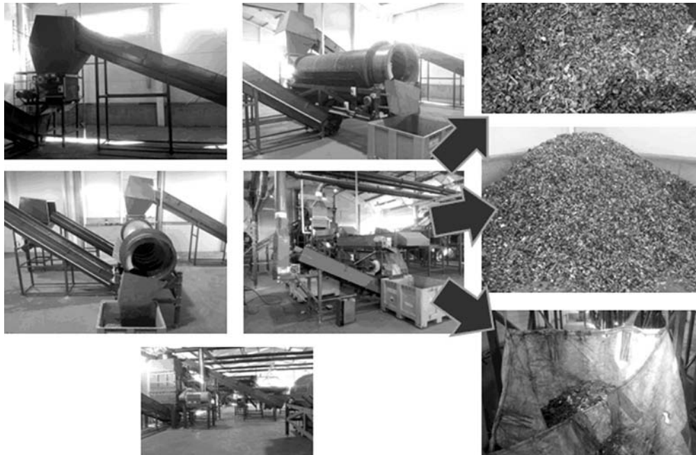
3. ábra: A fehérvárcsurgói szeparációs prototípus és az általa leválasztott anyagfrakciók
