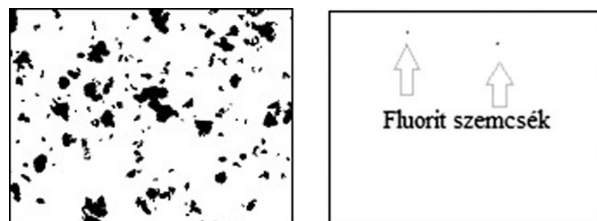
3. ábra: Optikai felvétel az 1 perces habtermékről (balra) és a cellamaradékról a képfeldolgozást követően (Flotisor SM-15:200 g/t, pH=9,5)
