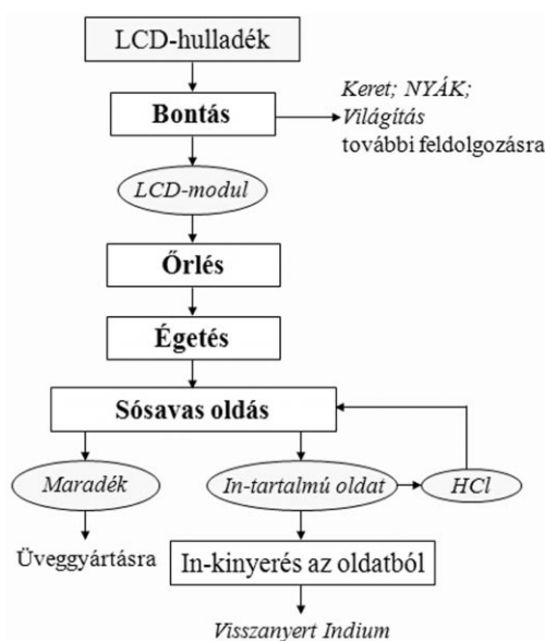
4. ábra: LCD kijelzők feldolgozása őrléssel, égetéssel és kénsavas/sósavas oldásos technológiával ([4] nyomán)
