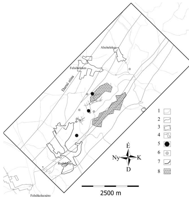
5. ábra: A savanyú pátvasérc előfordulása Rudabányán, az arany dúsulást harántoló fúrások feltüntetésével. Jelmagyarázat: 1. vízfolyások, 2. utak, 3. kutatási terület, 4. település, 5. 0,1 g/t meghaladó arany dúsulást harántoló fúrások, 6. a jelenlegi kutatási program egyéb elkészült fúrásai, 7. fő tektonikai zónák nyomvonalai, 8. savanyú pátvasércet harántolt fúrások 100 m-es sugarú közvetlen környezete
