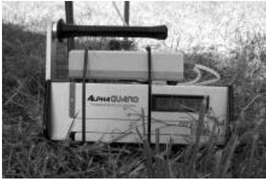
1. kép: AlphaGuard radon monitor a szükséges tartozékokkal (szivattyú, verőszonda, kalapács)
