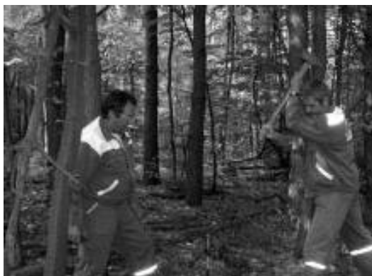
2. kép: Talajgáz mintavevő szonda leverése a terepen
