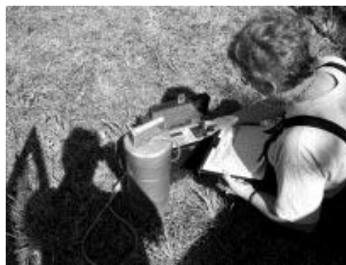
3. kép: Terepi gamma-spektrometriai mérés MÉV NK-484 típusú 4 csatornás berendezéssel
