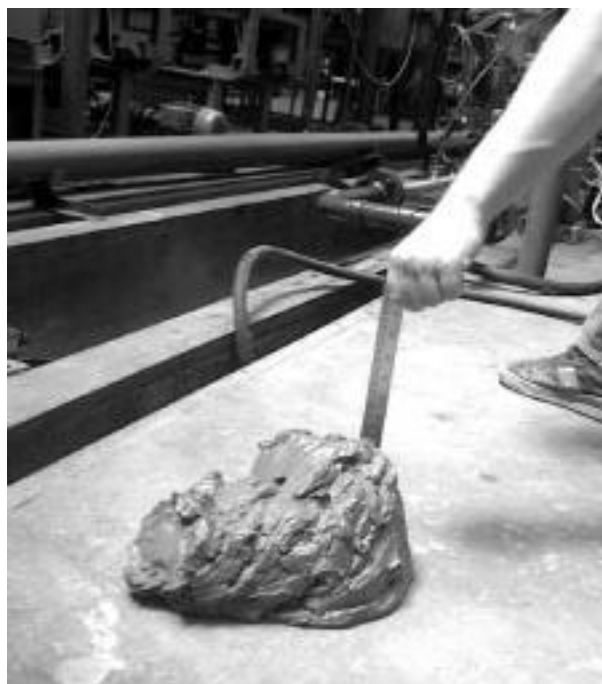
2. ábra: A gyöngyösoroszi flotációs meddő roskadás tesztje [4]
