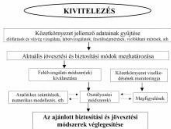
3. ábra: A kőzettest osztályozáson alapuló kivitelezés folyamatábrája [3]
