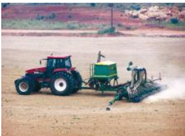
Gyepesítés pneumatikus vetőgéppel
