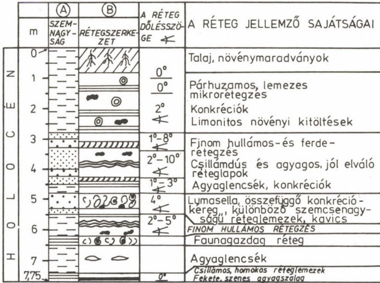
Рис. 2. Разрез слоев глиняного карьера кирпичного завода Кёрёшладань и некоторые характеристики свиты
