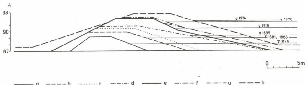
Рис. 8. Периоды стройки противопаводковой дамбы по реке Кеттёш—Кёрёш (левый берег; профиль 113+600)
