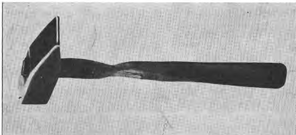
5. Kézi szegecseléstől elkoptatott kalapács, a munkásnő bevésődött ujjnyomaival, 1930.
