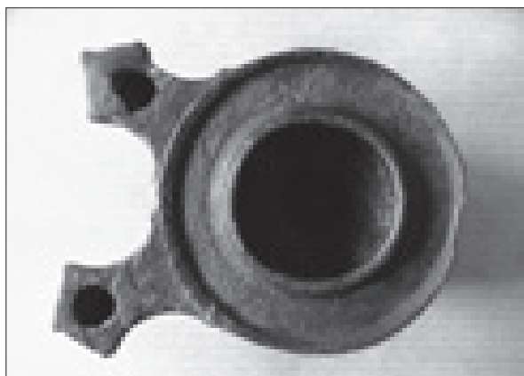
87. kép. A mécses külső profiljának öntés utáni kialakítása esztergálással lehetetlen, mert a nyakak nem teszik lehetővé a kész felületen való körbefutását.
