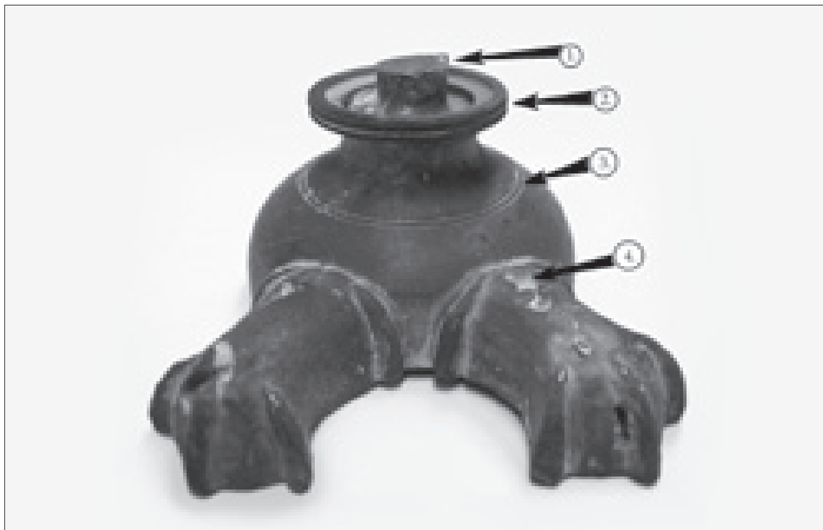
121. kép. A második viaszmécses nyers öntvénye. 1. A talpából kiálló öntési csomk; 2. A talpat díszítő hármás borda; 3. A mécses-testen körbefutó kettős vájat; 4. A beágyazó-anyag tömörségéből adódó öntési hiba.
