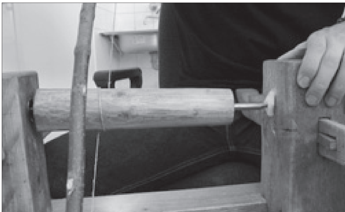
19. kép. Az eszterga az íjjal hajtott pont-kört maró fűrőfejjel. (készítette: VECSEY Ádám)
