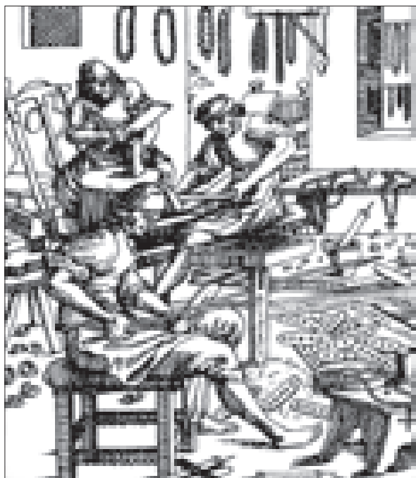
10. kép. Középkori rózsá-fűzért készítő műhely. Íjas fúróval. A fúró tengely egyik befogója egy rögzített lécz, a másik maga a megfúrandó munkadarab.
