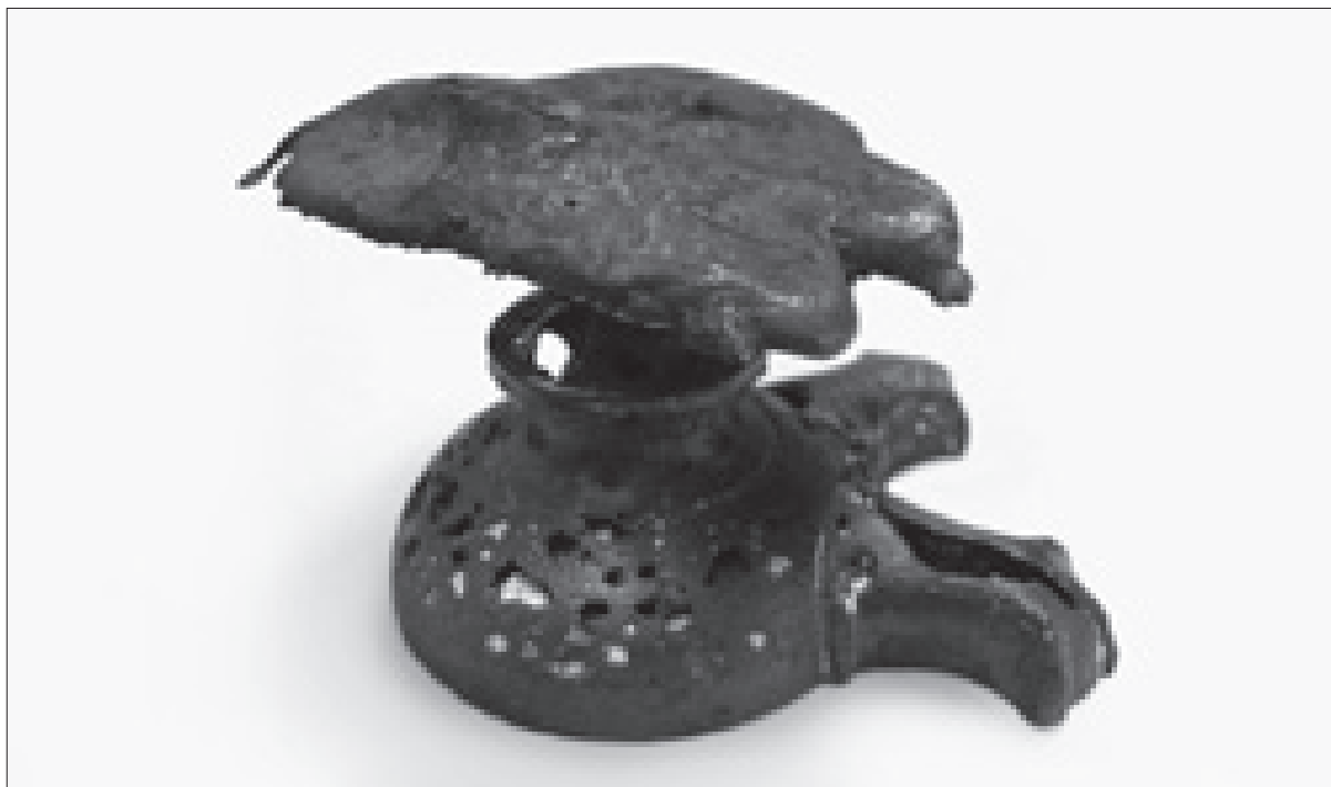
119. kép. Az első viaszmécses nyers öntvénye, a talpából kiálló öntési csomkkal és a beágyazó-anyag tetején szétterülő többletbronzal. A mécses felületén látható lyukak illetve záróányok a belső mag csekély gázáteresztő képességének az eredménye.
