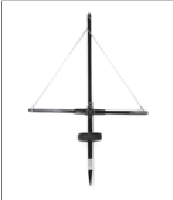
14. kép. Keresztfás-korongos fúró vagy pergőfurdancs. Tengelye oda-vissza forgó. A korong tömege segítségével (lendkerekes), a vízszintes keresztfa lenyomása után „felhúzza” magát, energiát „tárol” és a keresztfa ismételt lenyomásakor ellentétes irányba kezd el forogni.
