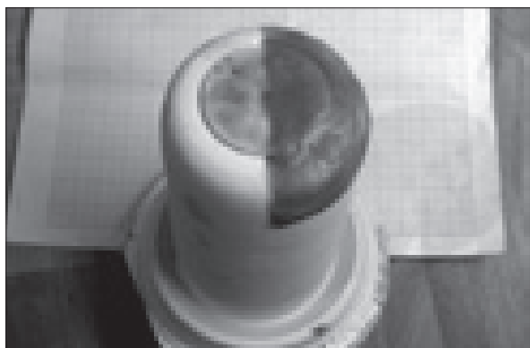
75. kép. A mérítő edény vékony falának kialakítása feltételezhetően összefüggésben van a viasz magra való felhordásának technikájával, ezért a második próbálkozásnál – a tűkör rekonstrukciójának készítéséhez hasonlóan – ecseteléssel vittem fel az olvadt viaszt a gipszmagra.
