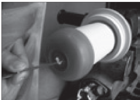
73. kép. A viasz esztergálásánál–forgácsolásánál a leválasztott viasz-forgácsot érdemes azonnal eltávolítani a késről, mert visszakenése a felületre komoly problémákat okozhat.
