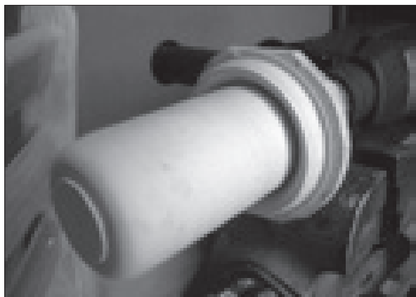
71. kép. A gipsz rudat a mérítő edény belső profiljával megegyező, pozitív formára esztergáltam
