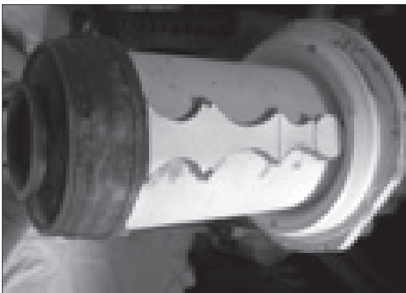
79. kép. A fül formája egy sablon és egy szike segítségével könnyedén kialakítható
