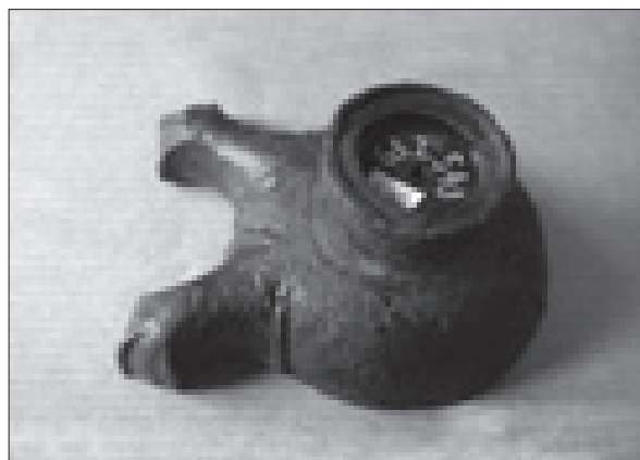
86. kép. A mécses testét esztergálással készíthették, de a nyakak és a test között nincs forrasztás, egy anyagból van öntve az egész mécses. Ez azt jelenti, hogy a test profiljának kialakítása a nyak felhelyezése előtt történt, tehát bizonyos, hogy öntés előtt történt az esztergálás is.
