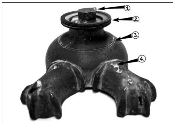
18. kép. Az egyik viaszmécses nyers öntvénye: 1. A talpából kiálló öntési csonk, 2. A talpat díszítő hármás borda, 3. A mécses-testen körbefutó kettős vájat, 4. A beágyazóanyag tömörségéből adódó öntési hiba.
