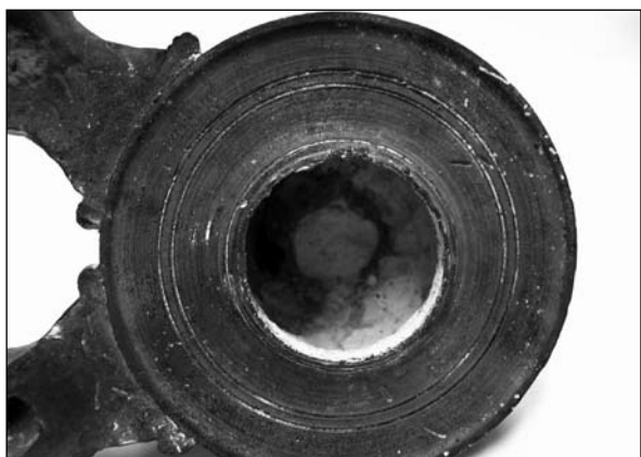
19. kép. Még a viasz felültén apró bordákat és árkokat hoztam létre, hogy megtapasztaljam mennyire finom kidolgozottságú felületet lehet kapni öntés után.
