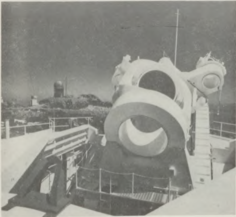
28. ábra. A McMath naptávcső 2 m átmérőjű héliosztát tükre
