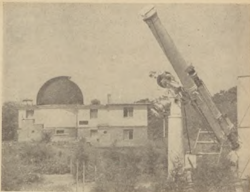
1/a. ábra. A debreceni Napfizikai Observatórium épülete, előtérben a 10"-es refraktor a rúszertelt 5"-es fotehéliográffal. Észleléskor a műszer teljesen a szabadban áll. A műszerház síneken északra eltolható. A kupolában nyert elhelyezést egy nagy 10"-es Cassegrain reflektor típusú fotehéliográf, míg a kupola előtti déli teraszon van a spektrohélioszkóp célosztója, innen a sugármenet függőleges irányban halad le a kupolahelyiség alatti sötét szobába, a spektrohélioszkóphoz
