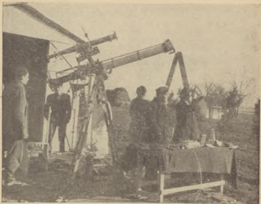
11j. ábra. A szilisztrai megfigyelő állomás, nem sokkal a teljes fogyatkozás előtt. A 6"-es fotehéliográf és egy 3"-es refraktor. Utóbbi is polarizációs észlelésre használtuk a fogyatkozáskor, egyébként a héliográf „ezpondló” távcső. (Ezen észlelő műszerünk Debrecenben a 10"-es refraktor közelében áll. Itt az ekratorialis, kis kocsira szerelve síneken gördíthető ki műszerházának déli ajtaján.) A kép jobboldalán két szilisztrai érettségiző diák azok közül, akik a fogyatkozási észleléseknél segítettek: a lipniki megfigyelő állomáson két ruszei főiskolai hallgató nyújtott hasonló segítséget. A hivatatosan mindössze 7 személyből álló és 1 hónapig tartó külföldi expedíció munkájába bekapcsolódtak még Hunyadi Ilona, Kánya István és Török István debreceni negyedéves egyetemi hallgatók is
