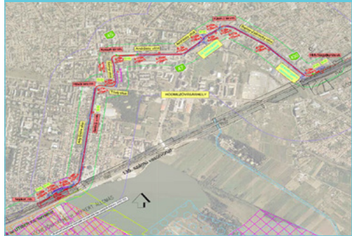
2. ábra: TRAM-TRAIN nyomvonal Hódmezővásárhelyen [4]
