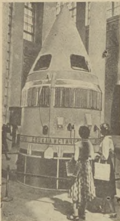
18/j ábra. Az 1959. jan. 2-án felbontott első lonyik, amelynek 1472 kg-os összsúlyából 361,3 kg volt a műszerek súlya
