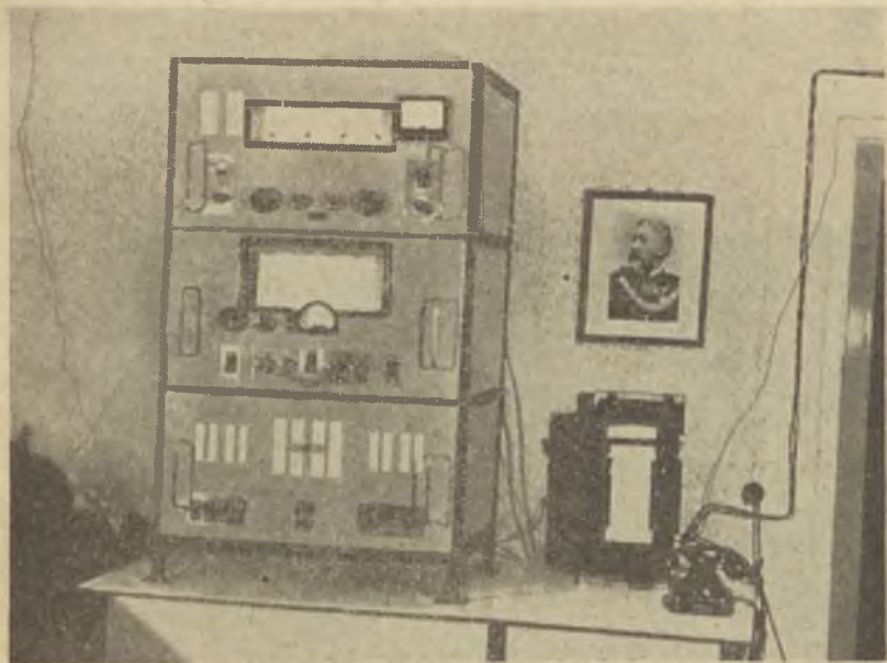
9. ábra. A bajai Városi Tanács Csillagvizsgáló Intézetének 43 csöves ionosféra vizsgáló, rádióberendezése (Tőle jobbra a regisztráló)
