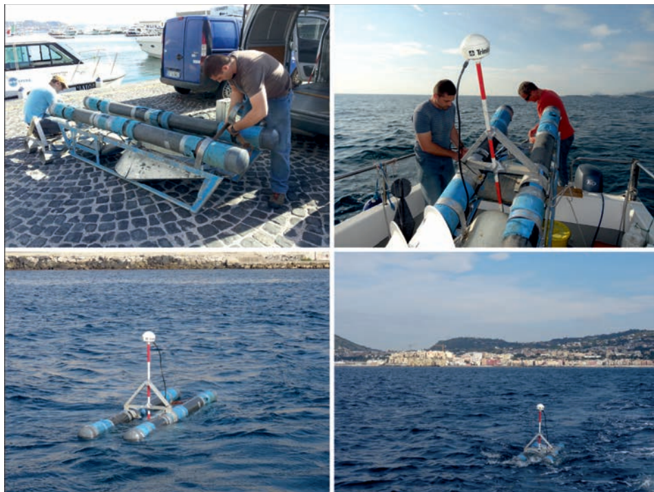
Figure 6. Set up of the IKB-Seistec boomer system and seismic profiling operations offshore Pozzuoli, Bay of Naples 6. ábra. Az IKB-Seistec szeizmikus mérőrendszer mérésre történő előkészítése és szeizmikus mérés Pozzuoli előterében a Nápolyi-öbölben
