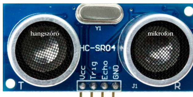
1. ábra. A HC-SR04 áramkör fényképe.
