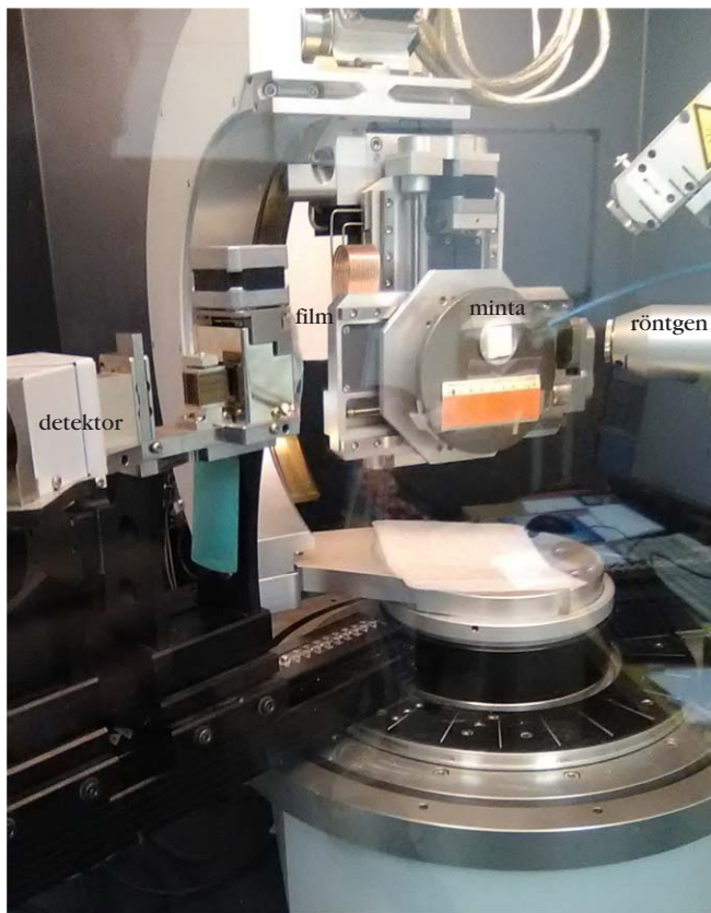
6. ábra. Balra modern röntgendiffrakciós készülék, mellette a minta diffraktogramja, az alatt röntgenfilmünkön a kijelölt négy maximumnak megfelelő vonal.
