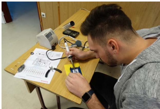
6. ábra. Alkatrész-beültetés forrástással.
