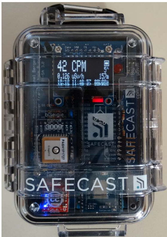
9. ábra. Az összeszerelt, betokozott detektor.
